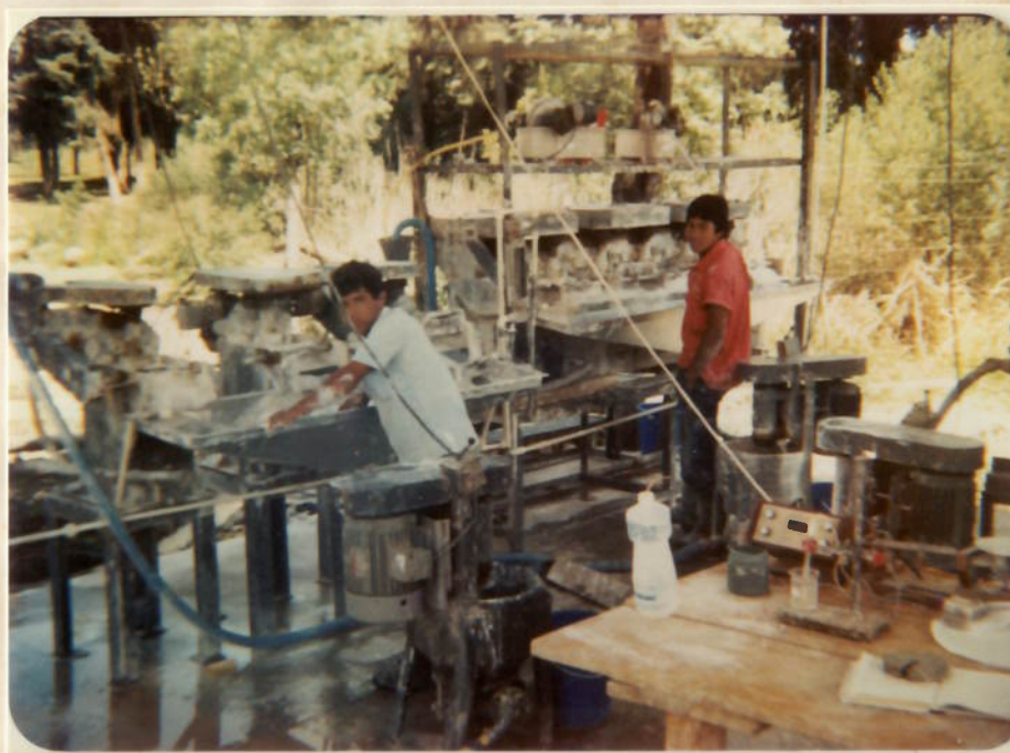
Figura 16 - Flotação de Talco em escala piloto, apresentando os estágios de flotação rougher e cleaner.
