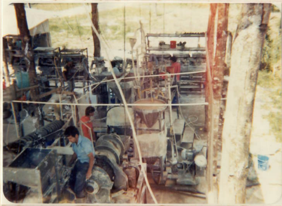
Figura 13 - Vista da Usina Piloto de Flotação de Talco, mostrando o circuito de moagem, deslamagem e flotação.
