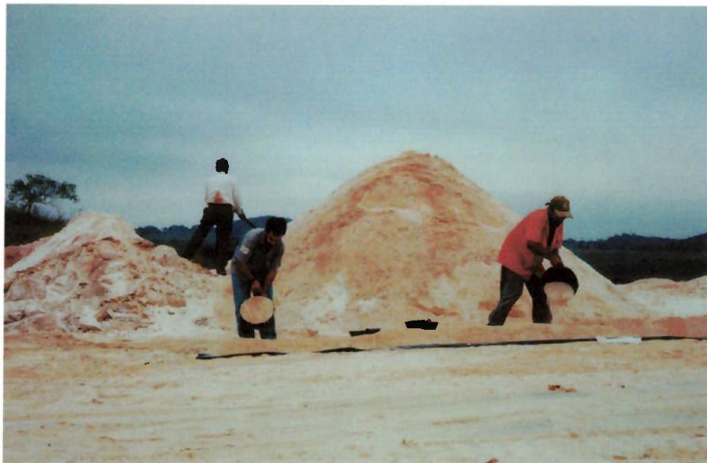
Fotografia 2 - Amostragem e subamostragem: reunião dos incrementos e formação da pilha alongada
