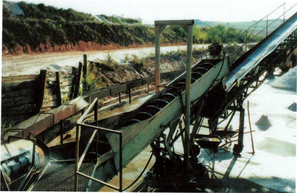
Fotografia 15 - Desaguamento por transportador helicoidal
