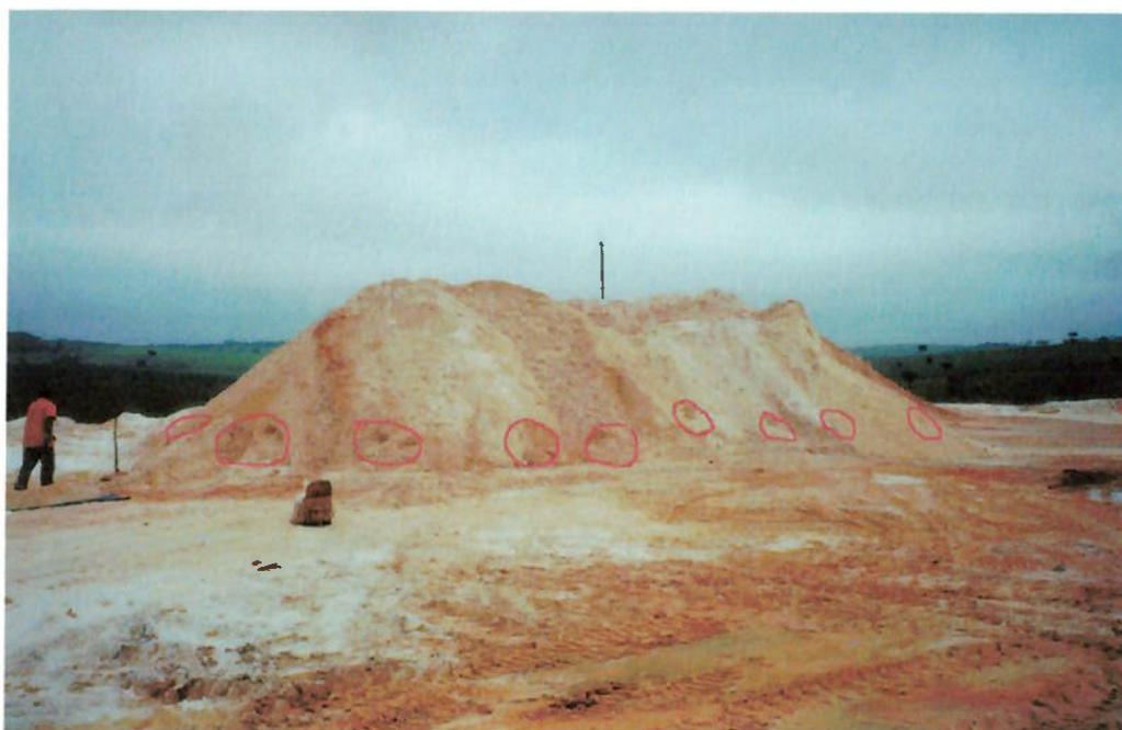
Fotografia 1 - Amostragem: as áreas assinaladas indicam os pontos de coleta de incrementos
