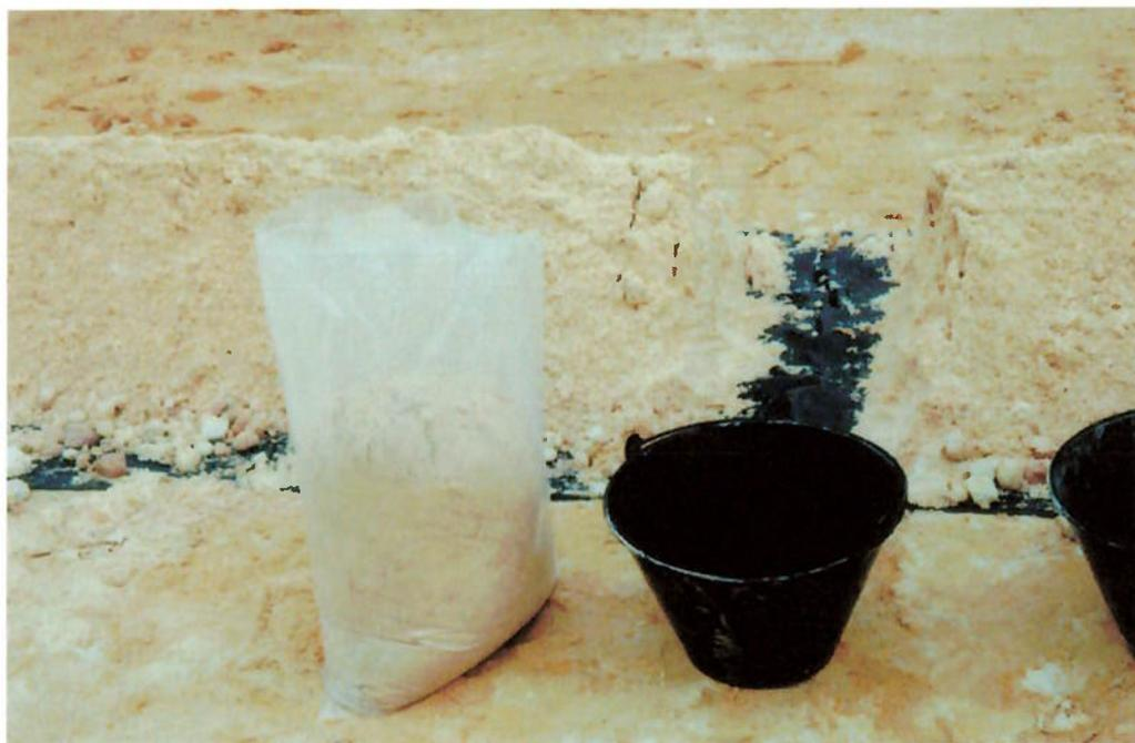
Fotografia 4 - Subamostragem: subdivisão da massa da amostra de campo e acondicionamento da amostra em saco plástico apropriado.
