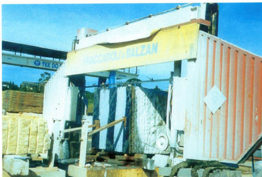
Figura 26 — Utilização do fio diamantado para cortar o bloco antes de o mesmo entrar no tear.
