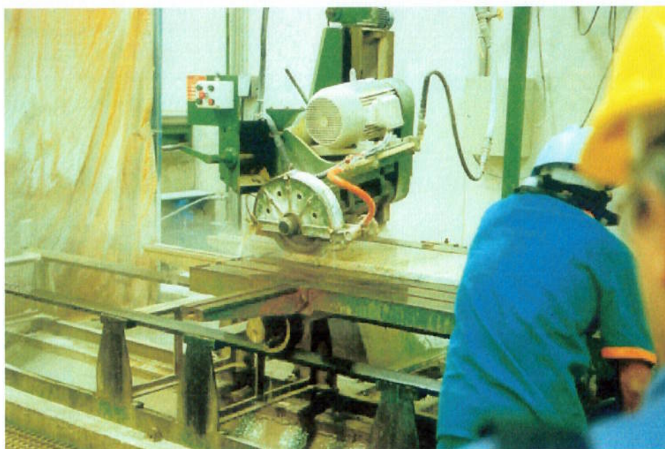
Figura 7 — Corte da chapa de rochas ornamental em ladrilhos através de disco diamantado. A água é utilizada para refrigeração do disco e do material.
