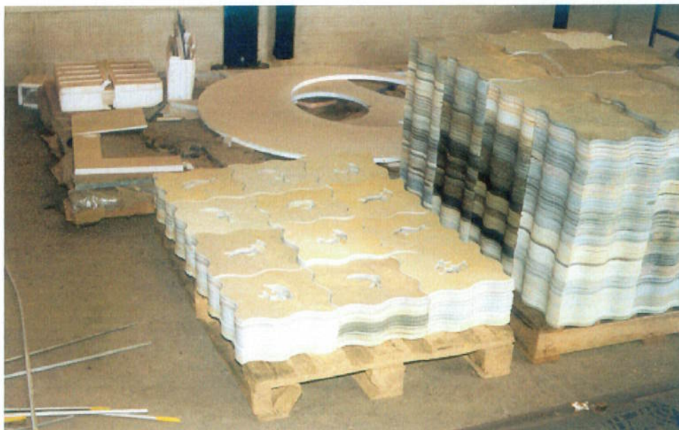
Figura 8 — Pilhas de ladrilhos de pedras ornamentais cortadas através do jato d'água abrasivo.
