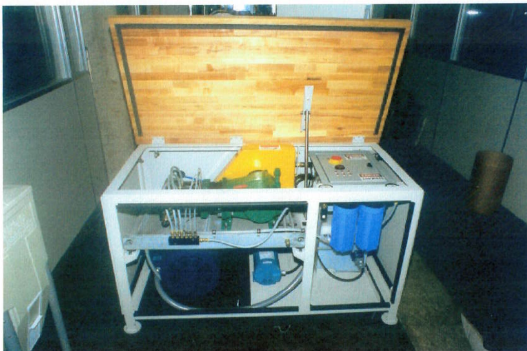
Figura 38 — Unidade de pressurização de água do equipamento de corte por jato d'água abrasivo.
