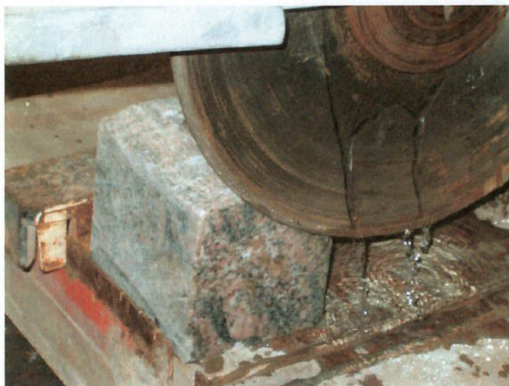
Figura 34 — Detalhe do equipamento de corte por disco diamantado. A profundidade máxima de corte é limitada pelo raio do disco.
