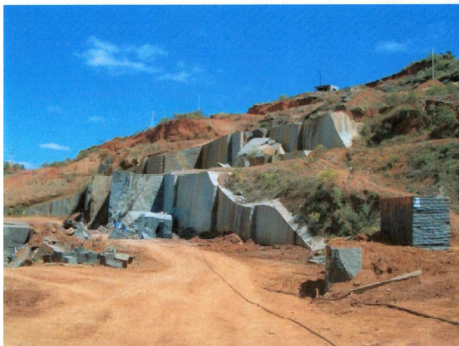
Figura 41 — Lavra de blocos do granito Preto Piracaia.
