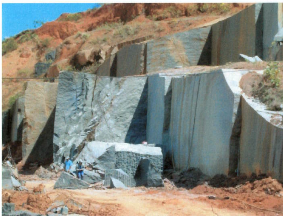
Figura 19 — Frente de lavra do granito Preto Piracaia, cortado através do fio diamantado.
