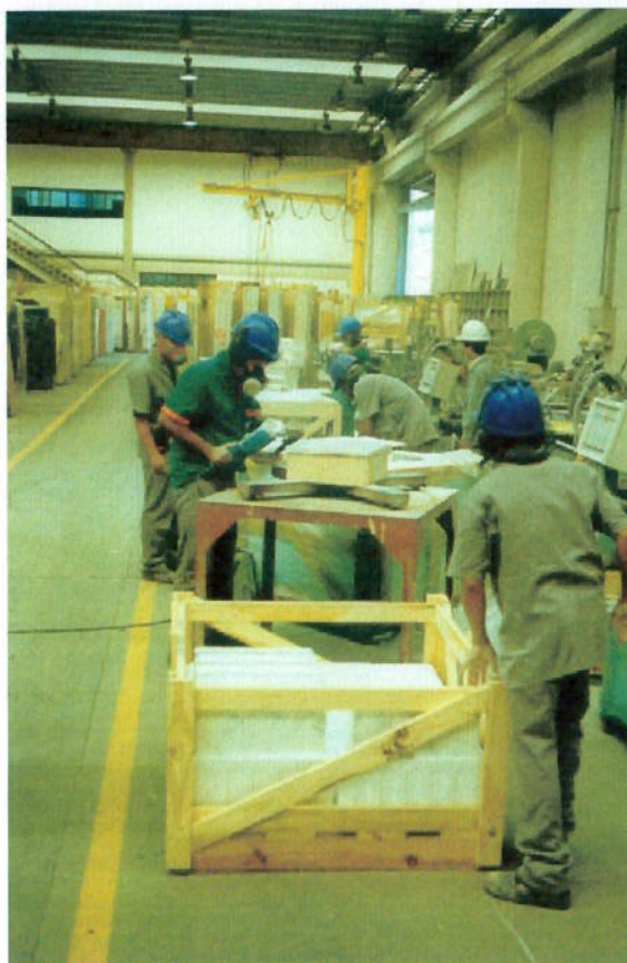
Figura 10 — Equipe de operários executando o acabamento final dos ladrilhos de rocha ornamental na YKK.
