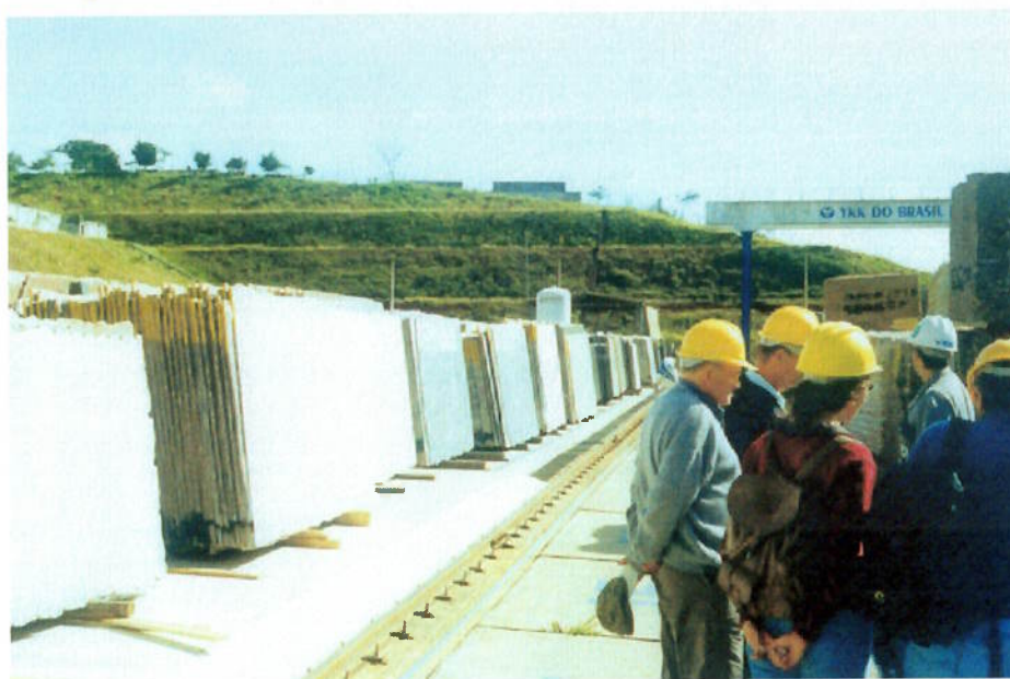
Figura 4 — Chapas de rocha ornamental quando retiradas do tear.
