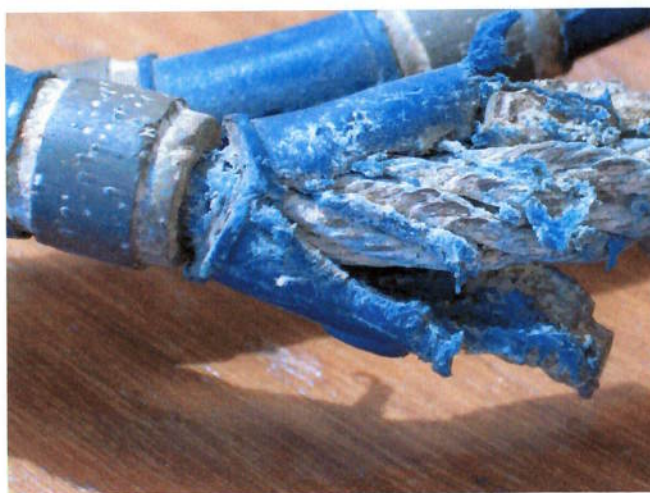
Figura 18 — Por meio deste fio diamantado danificado, podemos observar, além das pérolas diamantadas, o cabo de aço no interior do revestimento plástico.
