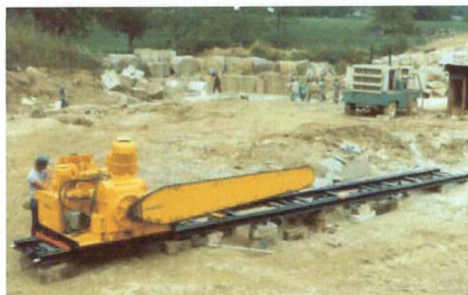
Figura 25 — Cortador a corrente diamantada sobre trilhos.*
