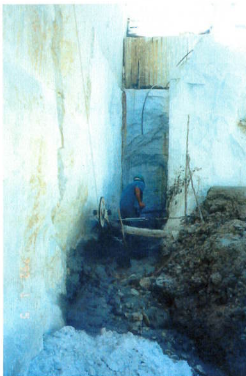
Figura 22 — Utilização do fio helicoidal para o corte de mármore*.
