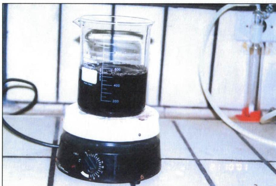
Figura 8.5- Ensaios de tratamento com turfa sob agitação magnética constante.
