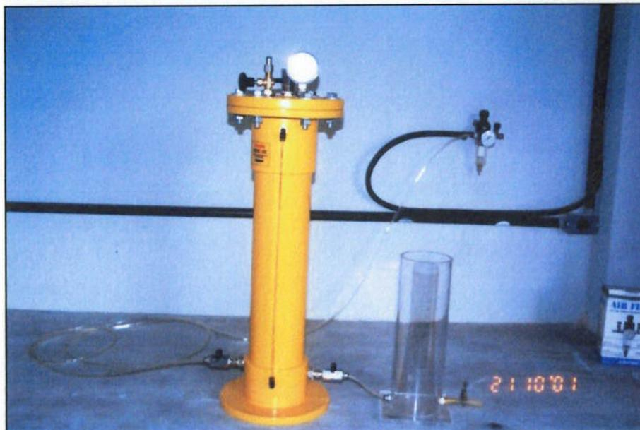
Figura 8.7- Sistema FAD utilizada nos ensaios em escala de bancada.
