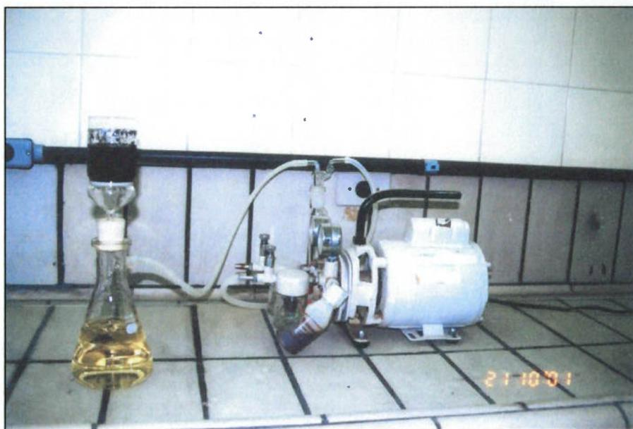
Figura 8.6- Ensaios de tratamento em coluna com turfa.
