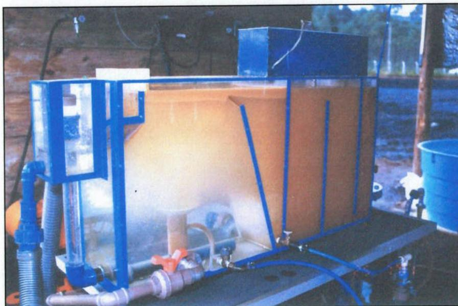
Figura 8.9- Célula FAD utilizada nos ensaios contínuos para o tratamento da DAM.
