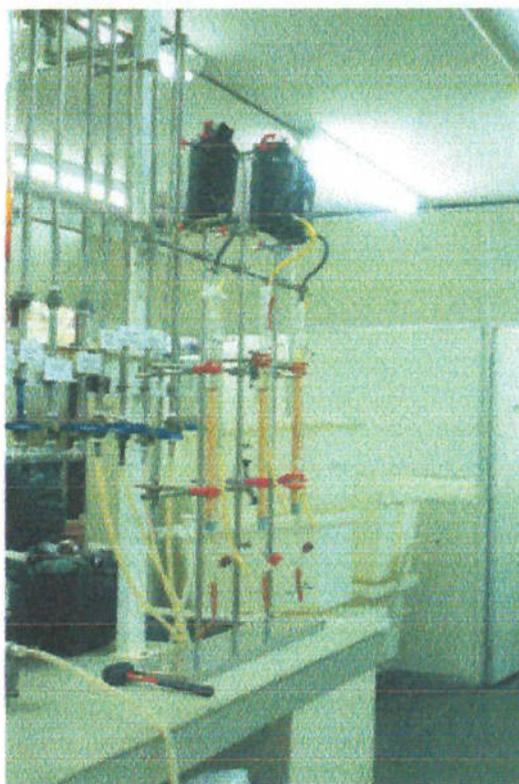
Figura 17 - Conjunto de colunas para operação em sistema descontínuo
