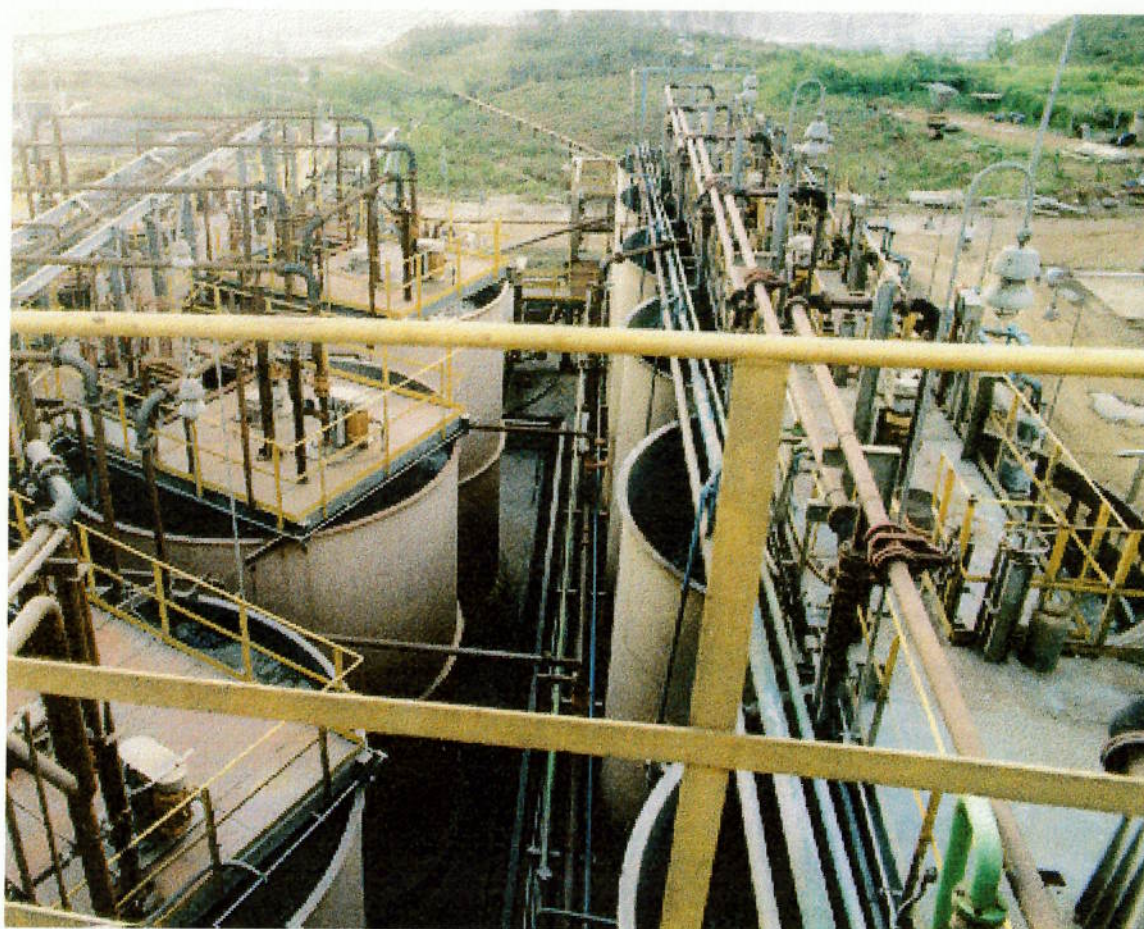
Figura 3.7- Tanques de cianetação do ouro da mina de Fazenda Brasileiro
