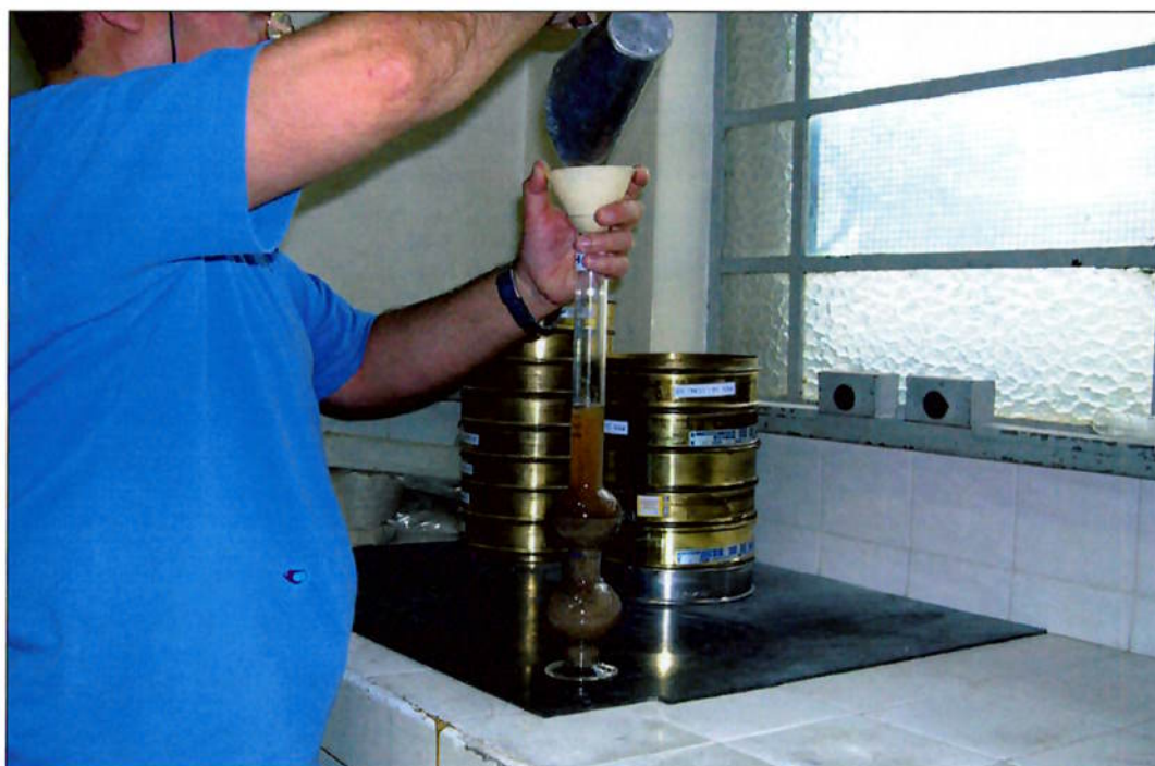
Foto 24 - Determinação da massa específica.
