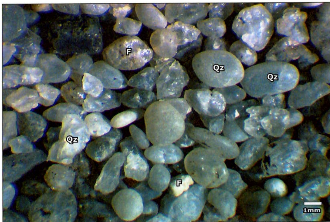
Foto 20 - Faixa granulométrica entre as malhas mesh #14 (1,2 mm) e #8 (2,4 mm). Notar heterogeneidade de formas dos grãos e texturas superficiais.
