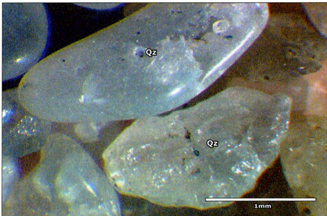
Foto 19 - Faixa granulométrica entre as malhas mesh #28 (0,6 mm) e #14 (1,2 mm). Comparação entre dois grãos de quartzo com arredondamento e textura superficial distintas.
