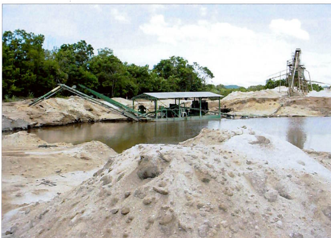
Foto 6 - Draga para extração de areia na Mineração Corrêa.
