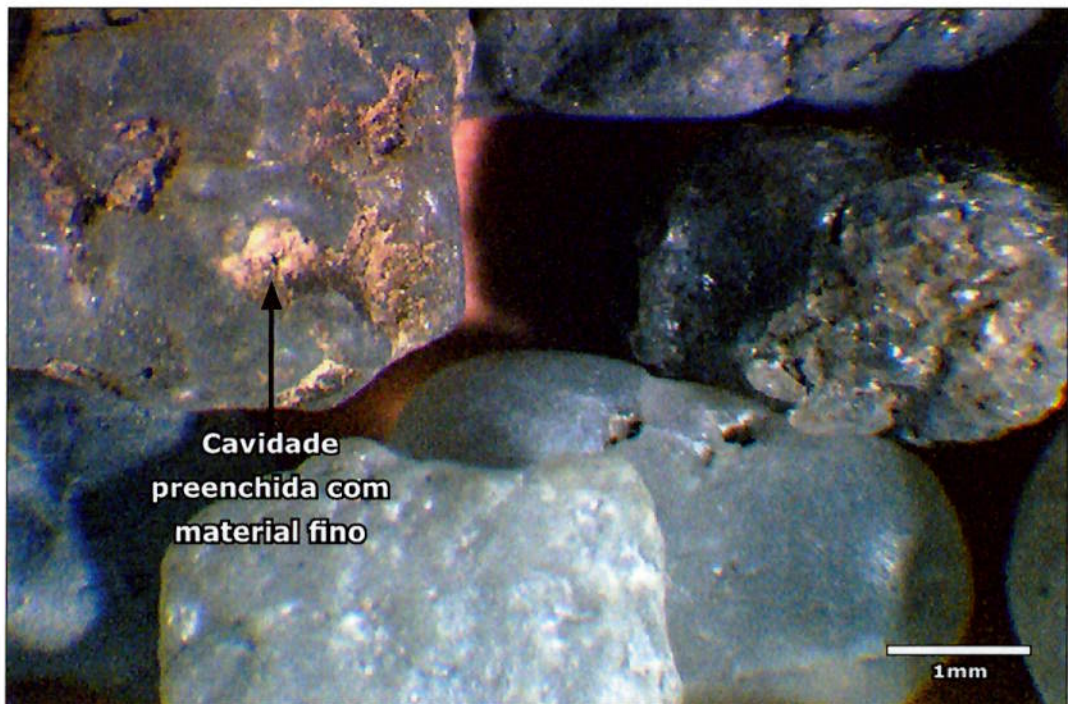
Foto 23 - Faixa granulométrica entre as malhas mesh #8 (2,4 mm) e #4 (4,8 mm). Notar grão com cavidade preenchida com material fino.
