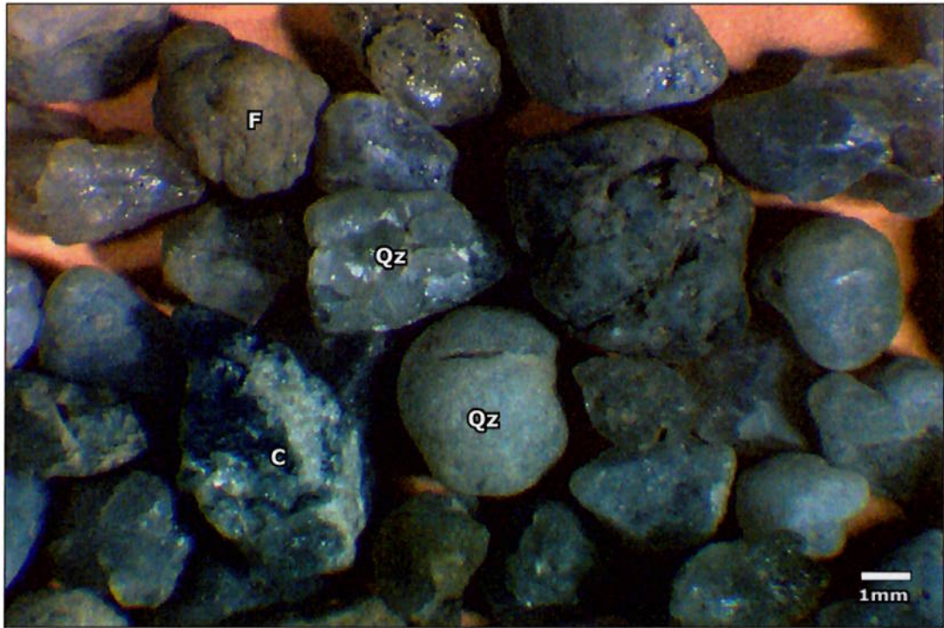
Foto 22 - Faixa granulométrica entre as malhas mesh #8 (2,4 mm) e #4 (4,8 mm). Notar que alguns grãos de quartzo bastante arredondados apresentam textura superficial áspera.
