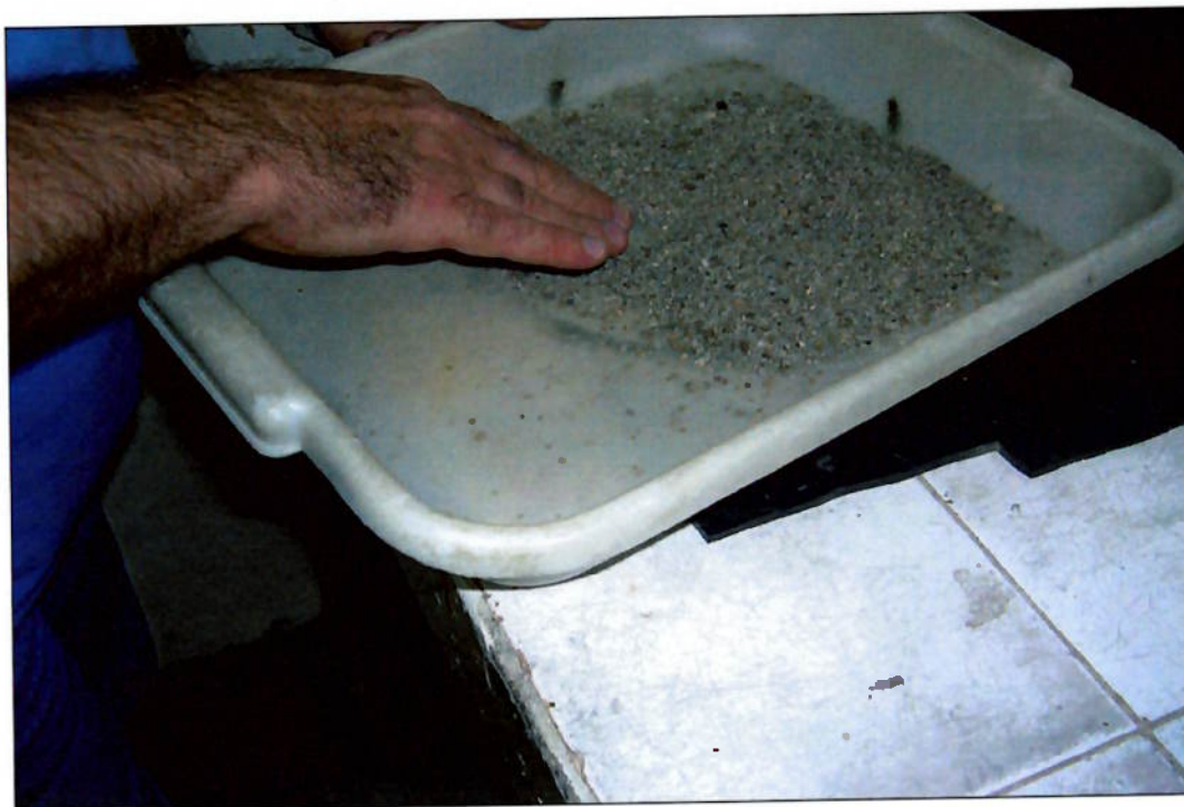
Foto 27 - Ensaio de determinação do teor de argila em torrões.
