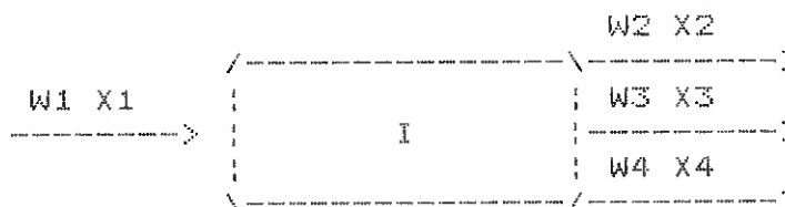
Figura 3: Uma operação unitária I, com um fluxo de alimentação e três de produto.
