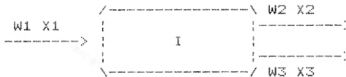
Figura 2: Uma operação unitária I, com um fluxo de alimentação e dois de produto.
