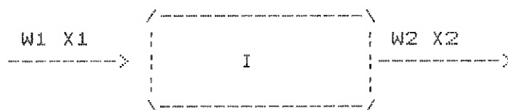
Figura 1: Uma operação unitária I, com um fluxo de alimentação e um de produto.
