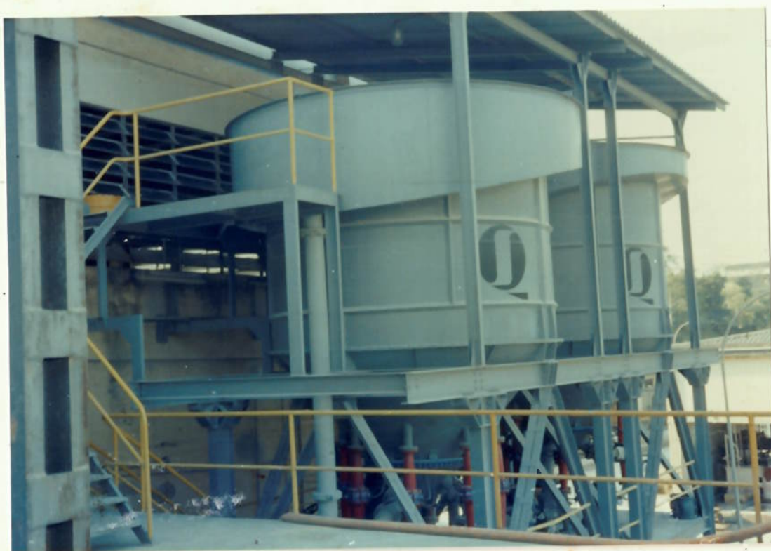
FIGURA 9.2. - CIRCUITO INDUSTRIAL, COM DUAS CÉLULAS SERRANA. EM PRIMEIRO PLANO, CÉLULA "SCAVENGER"; EM SEGUNDO, CÉLULA "ROUGHER"
