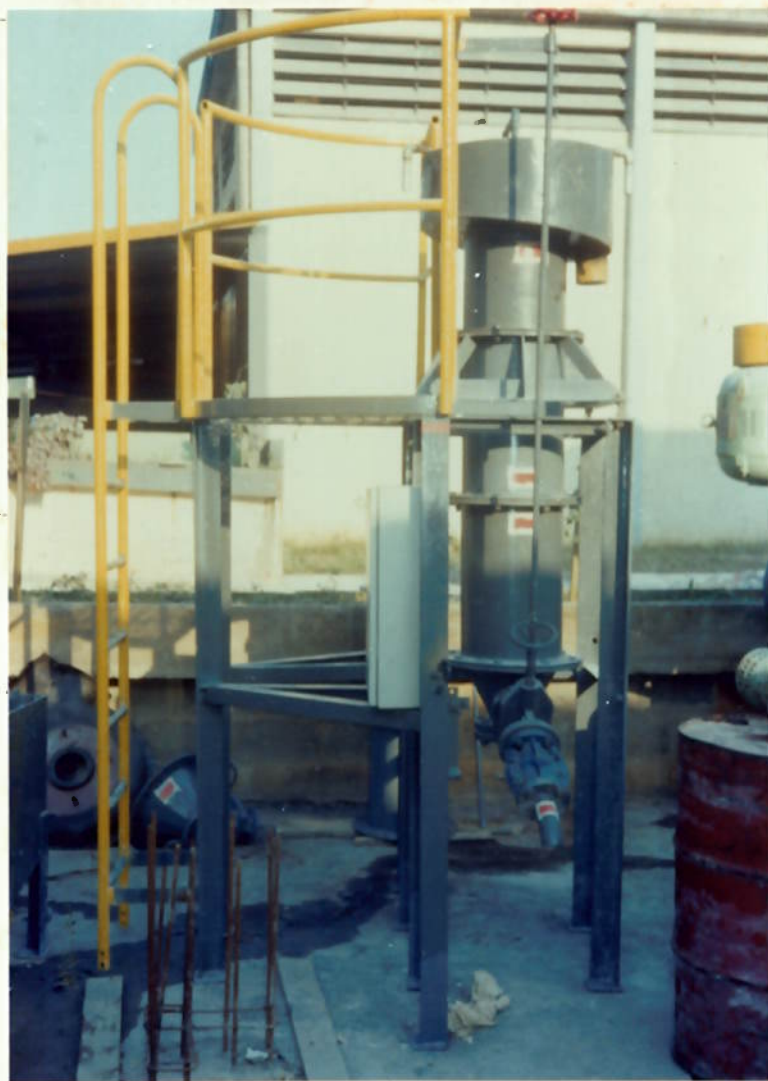
FIGURA 7.1. - A CÉLULA SERRANA DE FLOTACÃO PNEUMÁTICA - UNIDADE PILOTO
