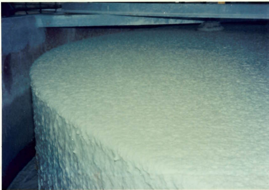
FIGURA 8.7. - OUTRA VISTA DO CONCENTRADO "ROUGHER", NOTANDO-SE A SUPERFÍCIE BASTANTE TRANQUILA DA ZONA DE ESPUMA
