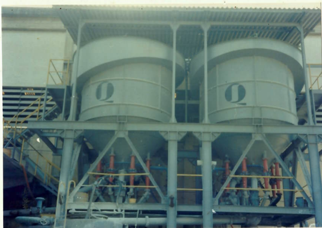
FIGURA 9.3. - VISTA DE FRENTE DO CIRCUITO, COM AS DUAS CÉLULAS DE ALTURA TOTAL (TANQUE + DISTRIBUIDOR DE POLPA) DE 5,2m E DIÂMETRO DE 3,7m, VOLUME ÚTIL DE 37m 3 /CADA. ABAIXO, VÊEM-SE OS CONJUNTOS DE AERAÇÃO (AERADORES), CADA CÉLULA COM OITO UNIDADES (EM VERMELHO)
