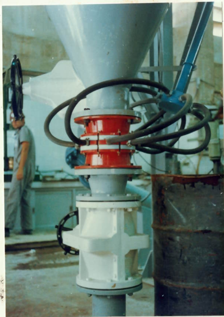
FIGURA 8.5. - DETALHE DO AERADOR DA CÉLULA "ROUGHER", COM ENTRADAS PERPENDICULARES DE AR (MANGUEIRAS NEGRAS)
