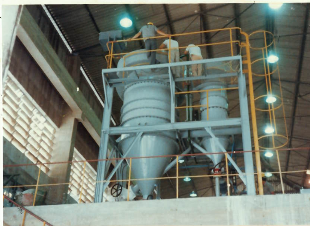
FIGURA 8.3. - CONJUNTO SEMI-INDUSTRIAL DE CÉLULAS "ROUGHER"/ "CLEANER", ESQUERDA/DIREITA, RESPECTIVAMENTE. NOTAM-SE OS ANÉIS QUE PERMITEM ALTURAS VARIÁVEIS DE OPERAÇÃO
