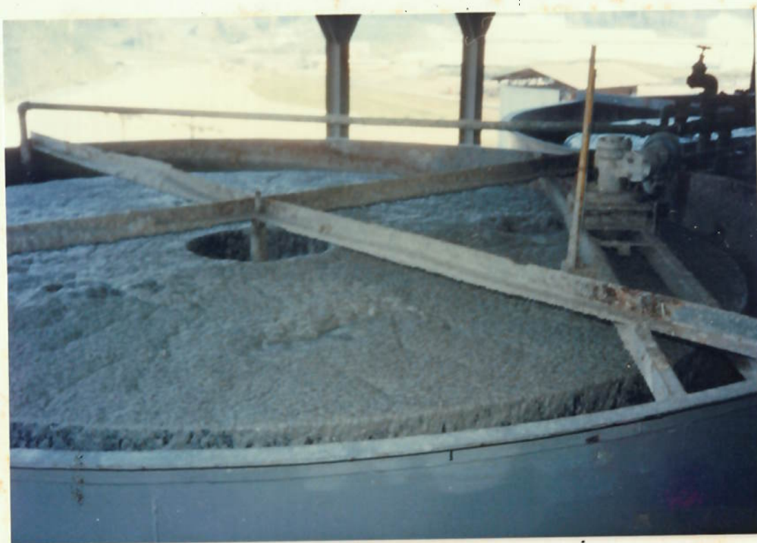
FIGURA 9.5. - DETALHE DA ZONA DE ESPUMA DA CÉLULA "ROUGHER"; A DESCARGA CENTRAL DE CONCENTRADO MINIMIZA O TEMPO DE TRANSPORTE DE PARTÍCULAS COLETADAS, IMPORTANTE CARACTERÍSTICA PARA ESTA OPERAÇÃO, COM ESPUMA DE ALTA CONCENTRAÇÃO DE SÓLIDOS E ALTA VISCOSIDADE
