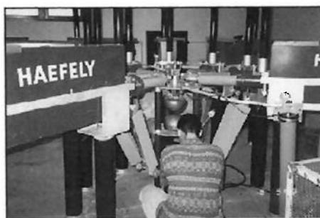
**Fig. 4.11** Preparação e montagem do circuito elétrico gerador de impulso de alta corrente.
