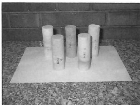
**Fig. 4.5** Foto de corpos de prova para ensaio de compressão uniaxial.
