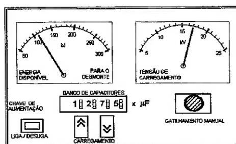
(b) esquema alternativo de uma mesa de controle de um gerador de impulso de corrente
