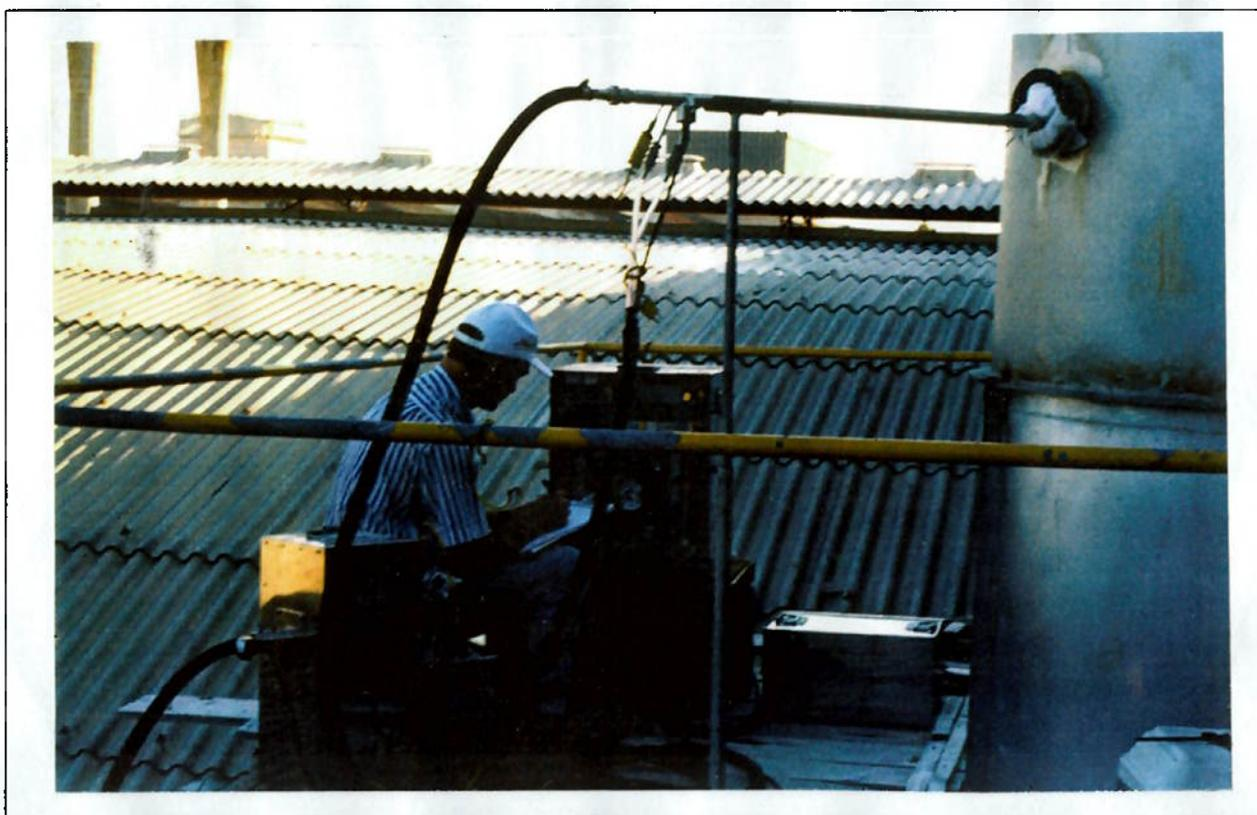
**Fig. 5 – Coleta de material particulado na chaminé do filtro de mangas.**
