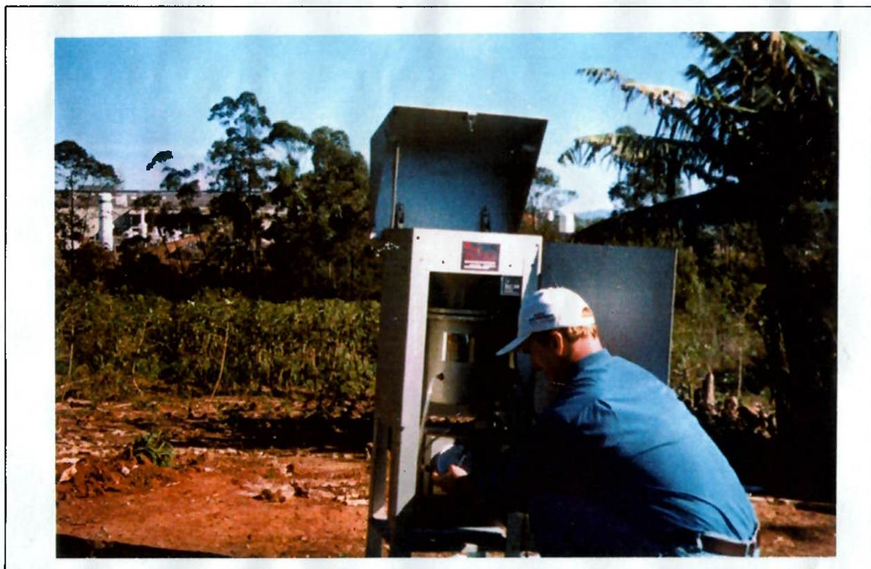
**Fig. 9 – Coleta das partículas totais em suspensão no sentido leste da fonte de emissão com a fábrica ao fundo – Içara/SC.**
