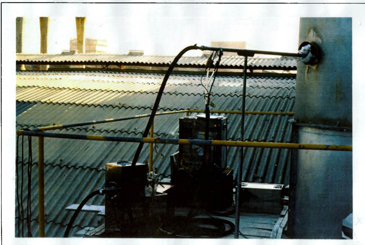
**Fig. 4 – Coletor Isocinético de Poluentes Atmosféricos.**
