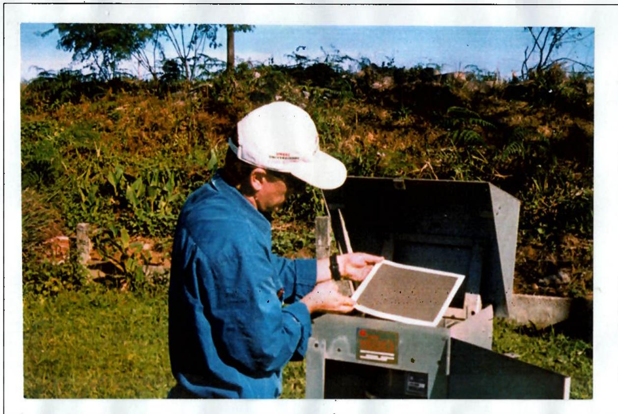
**Fig. 8 – Detalhe das partículas totais em suspensão após a coleta.**
