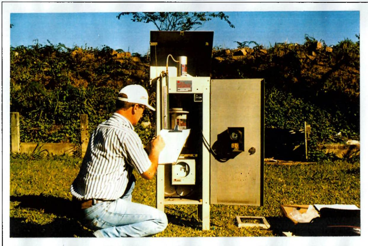
**Fig. 6 – Calibração do amostrador de grande volume.**
