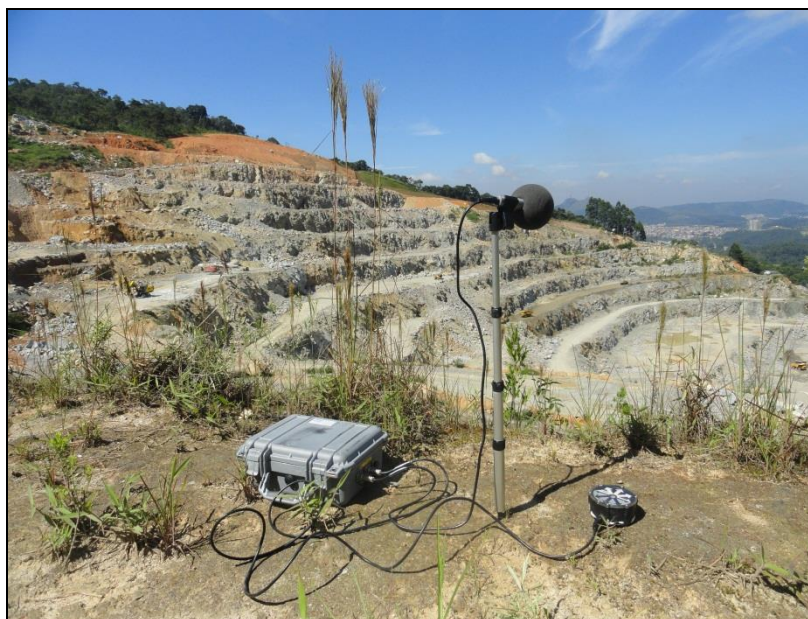
Figura 20- Geofone do sismógrafo fixado no solo para medição Fonte: Arquivo pessoal, 2012.
