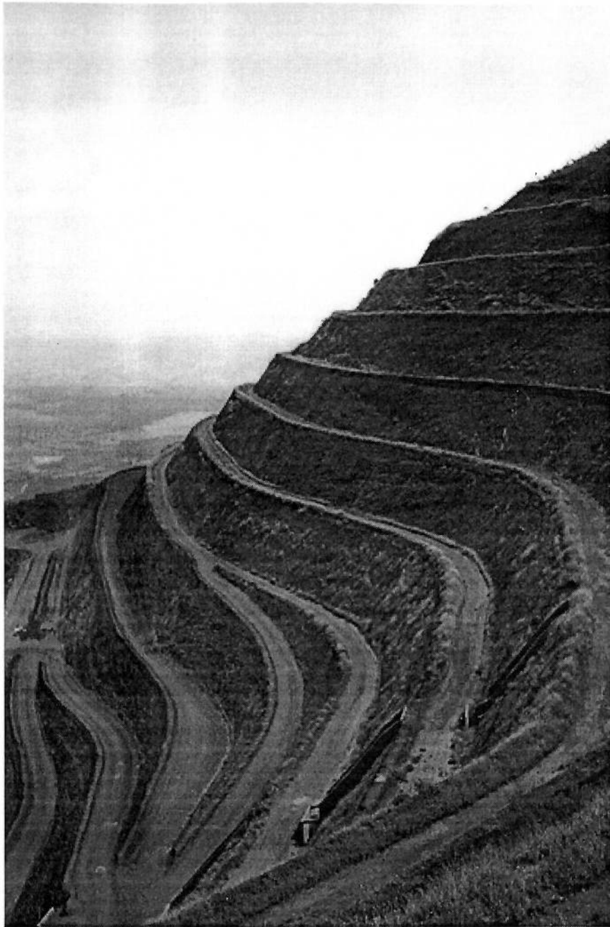
Figura 5.17. Vista do talude final da cava, com bancadas definitivas - Mina de Córrego do Feijão
