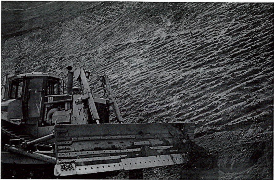
Figura 5.18. Retaludamento de bancada para a configuração de cava final - Mina de Córrego do Feijão
