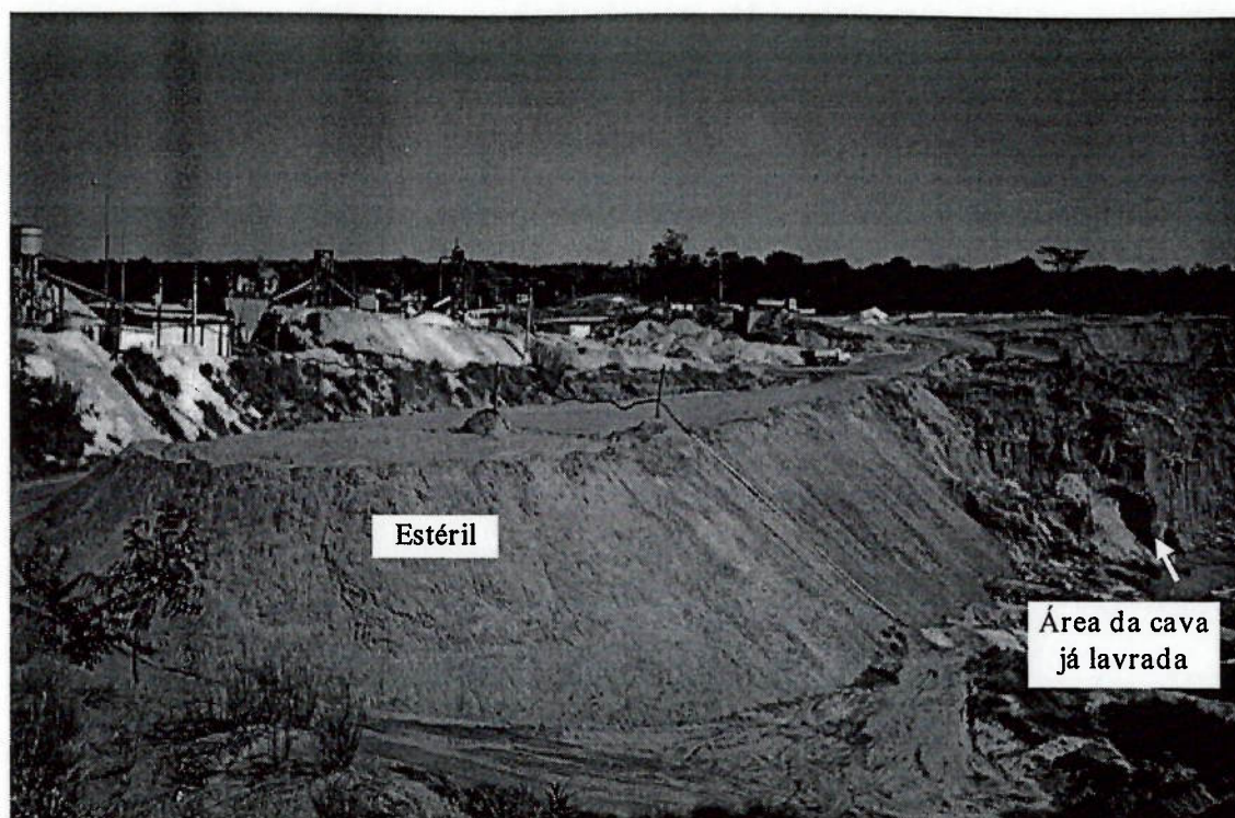
Figura 5.8. Deposição de estéril no interior da cava
