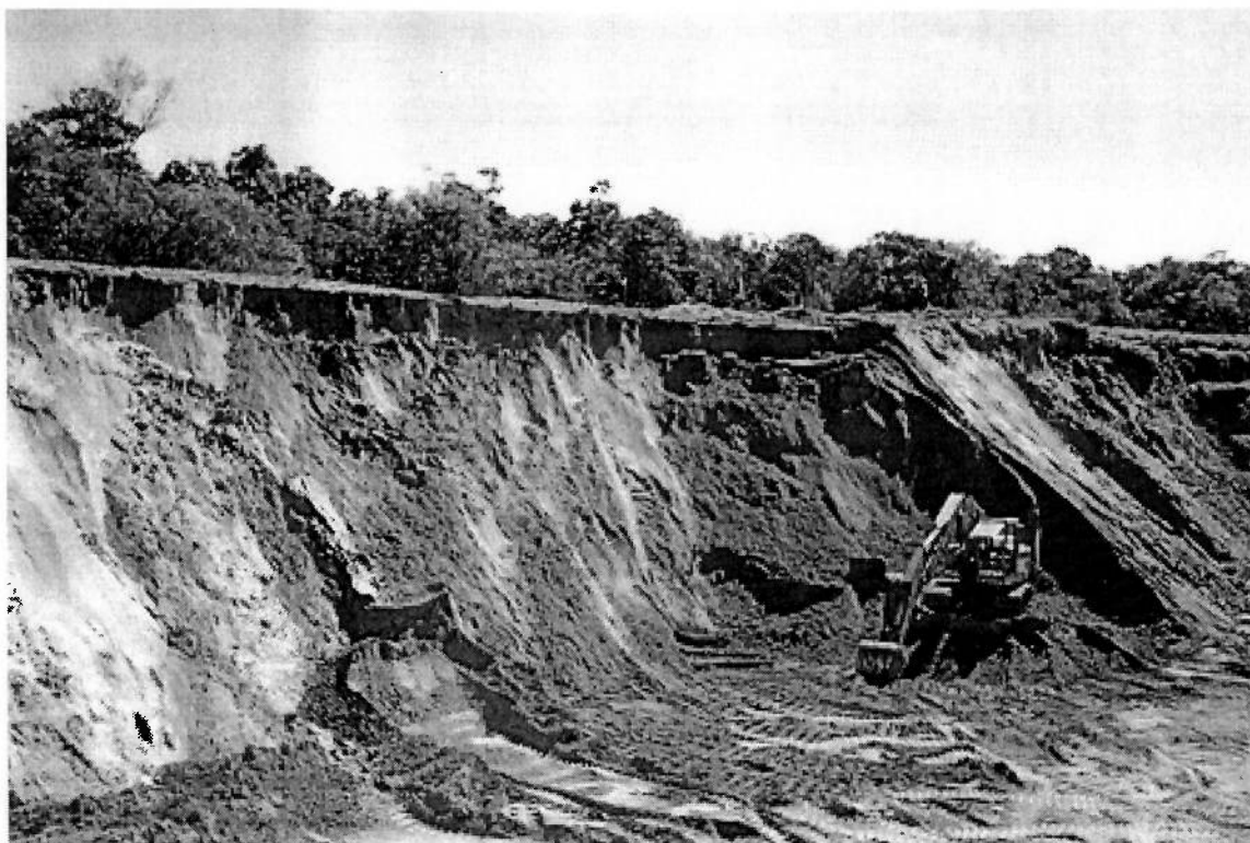
Figura 5.2. Lavra do arenito por escavação direta
