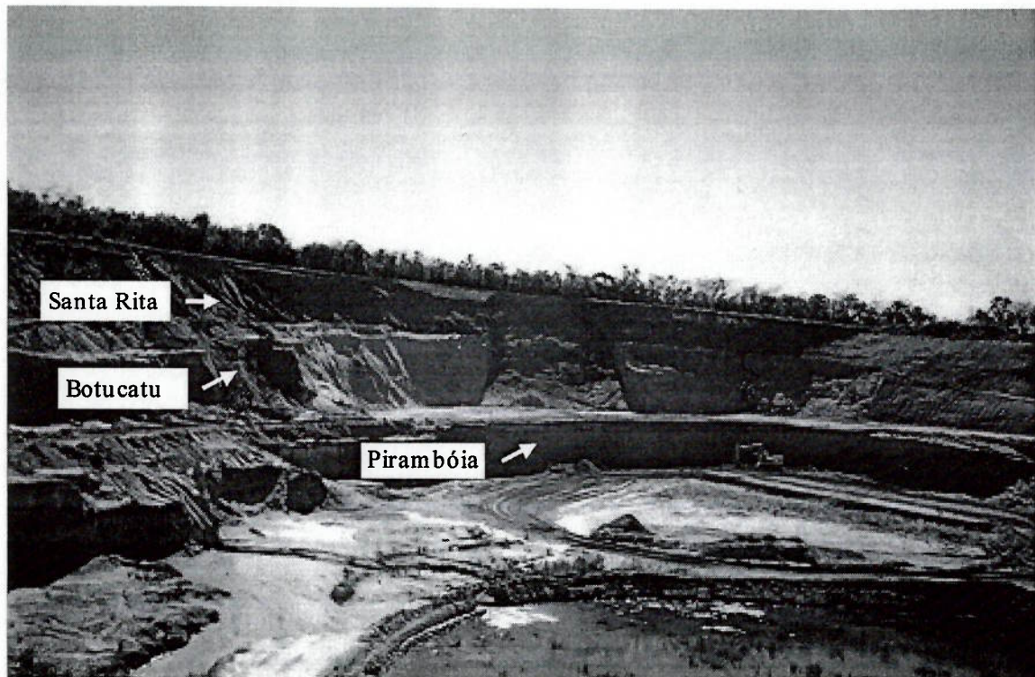
Figura 5.3. Vista da cava, com as três camadas de arenito em lavra
