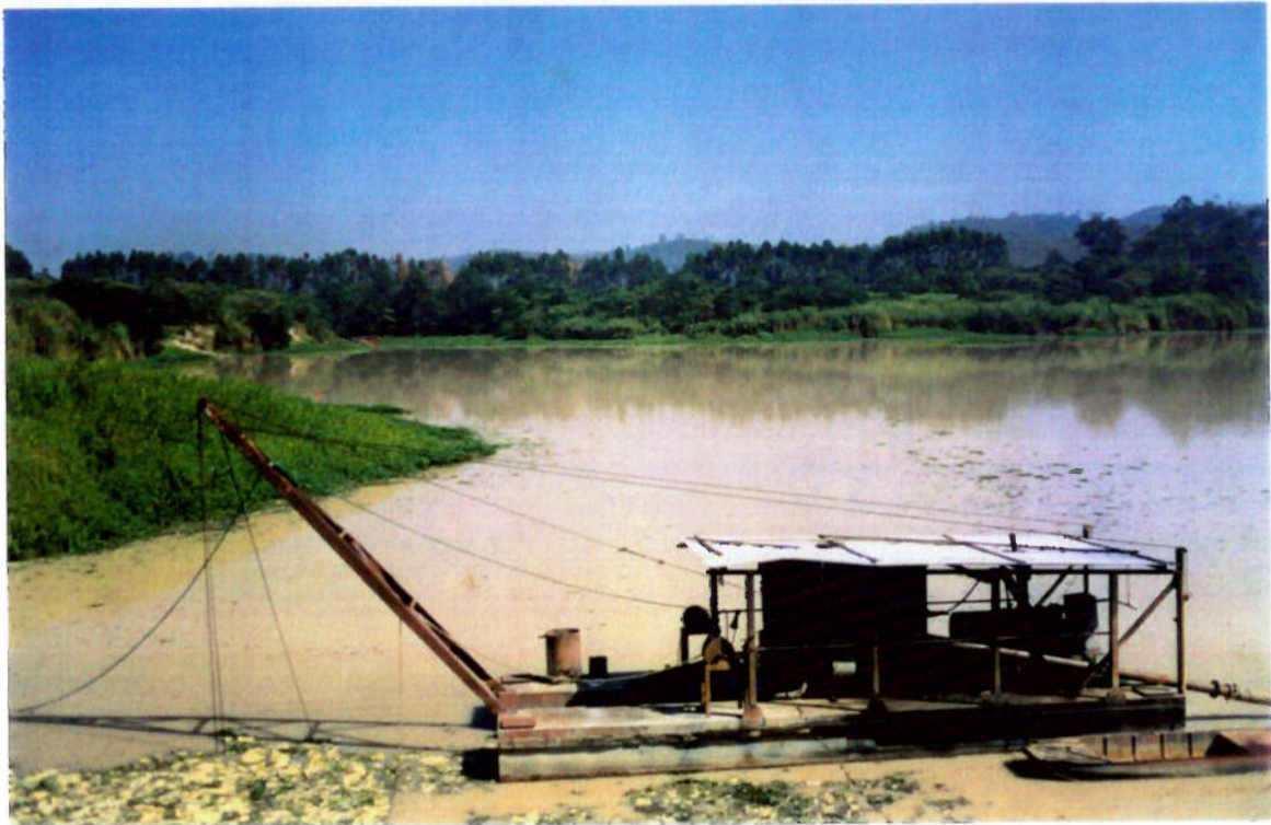
Foto 1: Draga flutuante (embarcada) estacionada no porto Navegantes.
