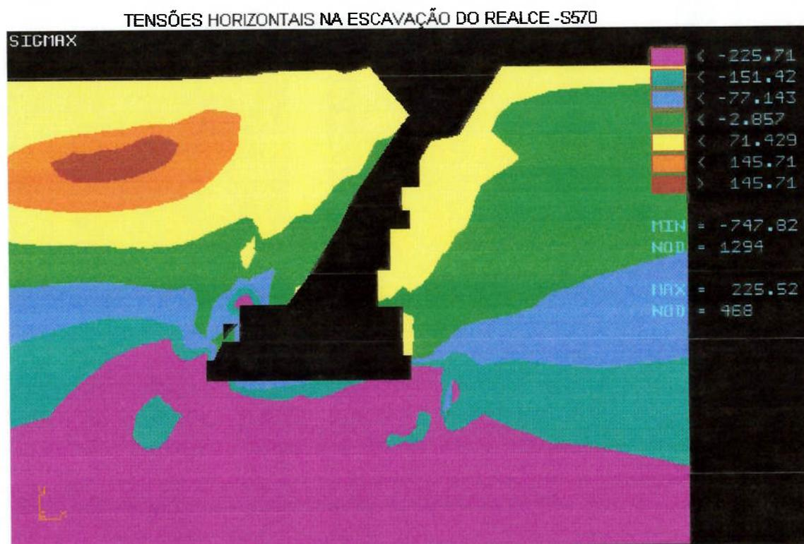
Figura 7.5 - Detalhe das tensões horizontais na região do realce aberto
