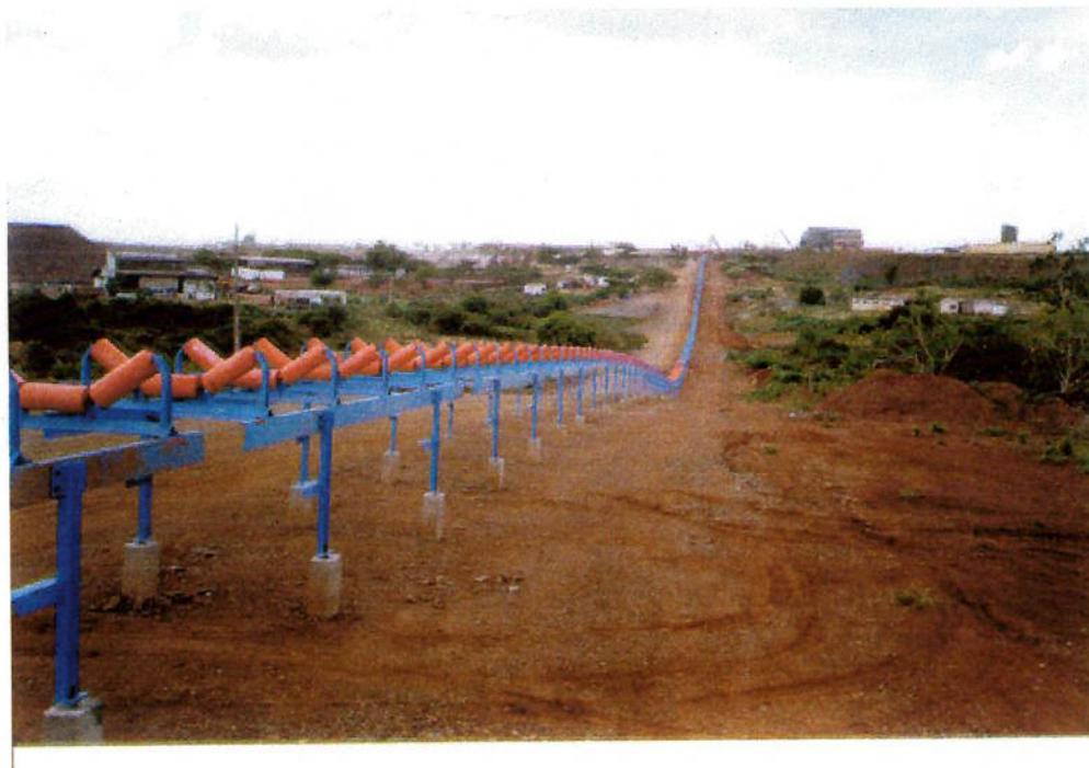
Foto 7. – Instalações da correia transportadora de minério no sentido à usina.
