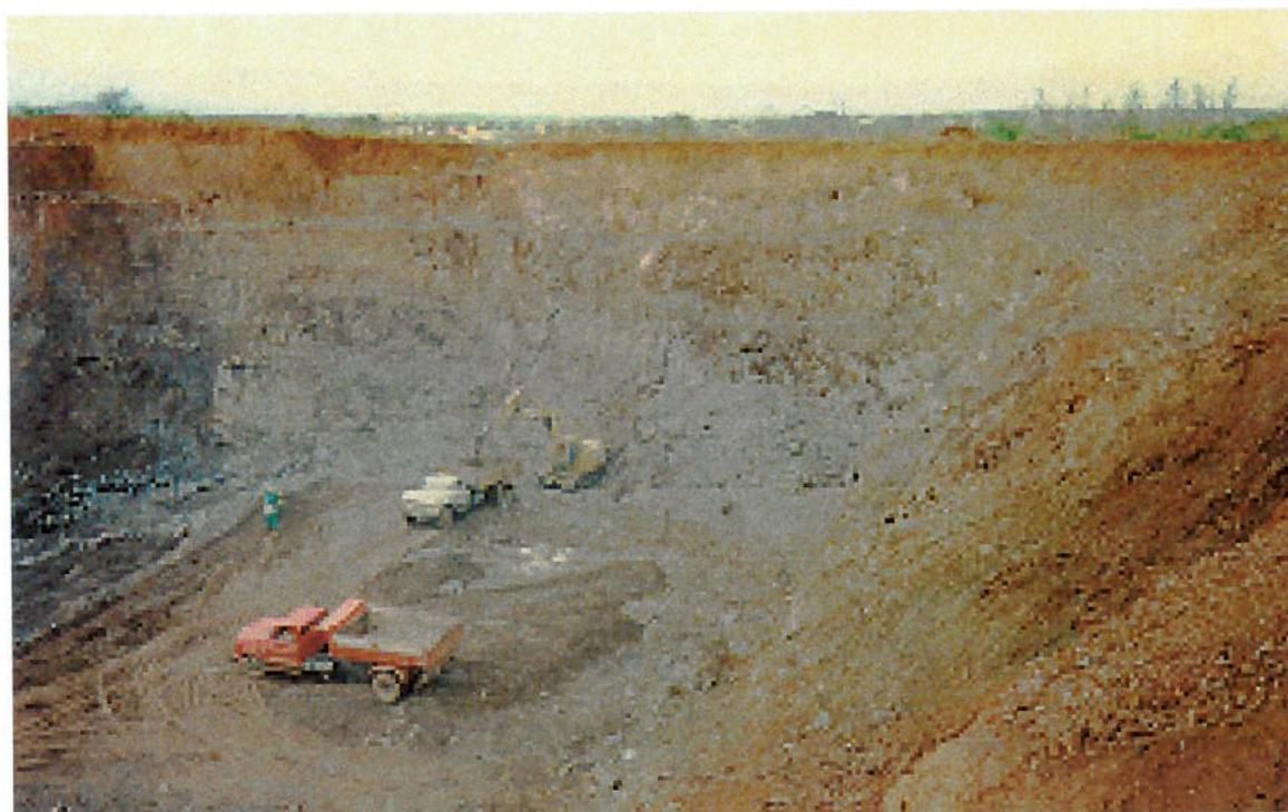
Foto 1 – Sistema de carga e transporte por caminhões basculantes.
