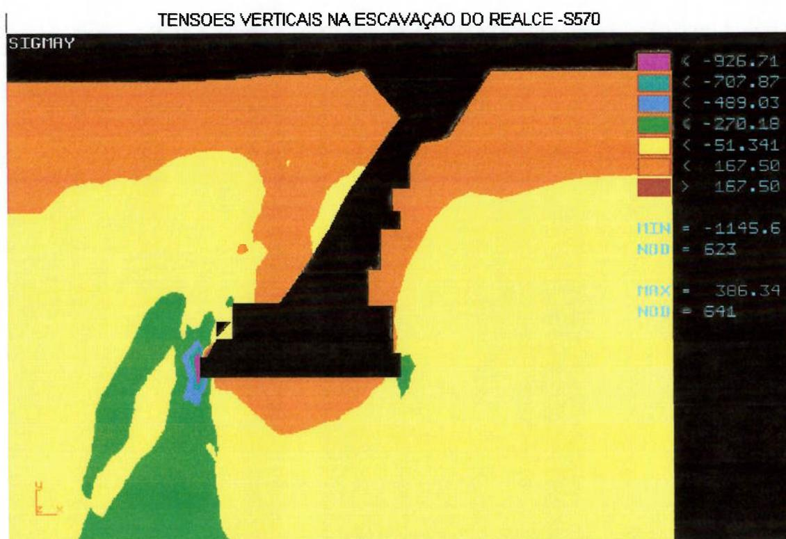
Figura 7.6 - Detalhe das tensões verticais na região do realce aberto
