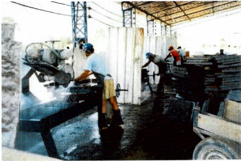
Figura 1.5 - Corte de lajes em serras de disco diamantado.
