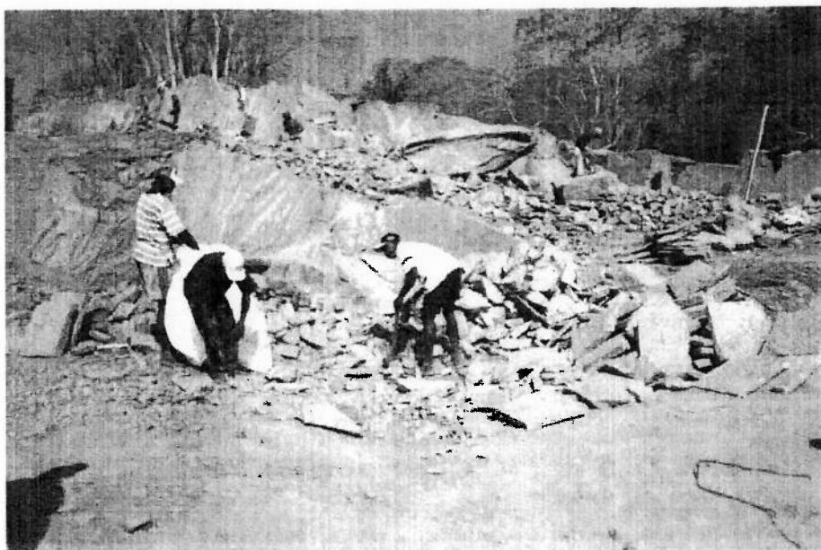
Foto 26 - Coleta de rejeitos de pedreira
