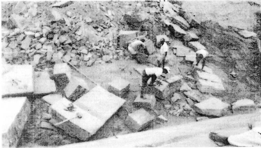
Foto 8 - Vista geral do trabalho de divisão dos blocos, em pedreira de Pádua
