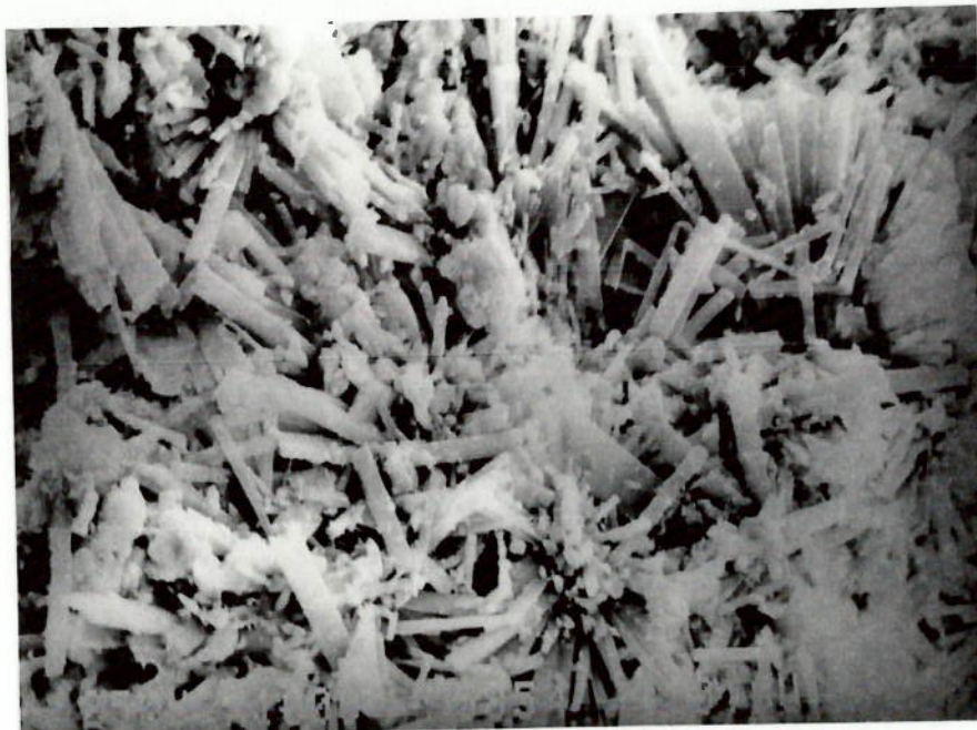
Figura 4.24 – Fosfogesso na superfície da apatita APG. (MEV - aumento de 1000X)
