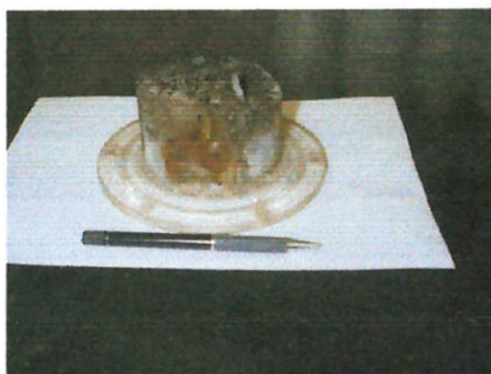
Fotografia 5.6 – Camada dura formada a partir da cinza + corretivo alcalino.
