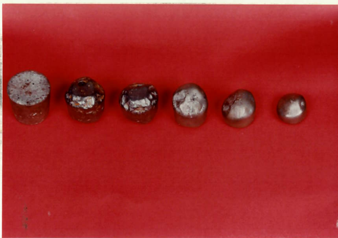
fig. 5.14 Evolução de um cylpeb durante ensaio
