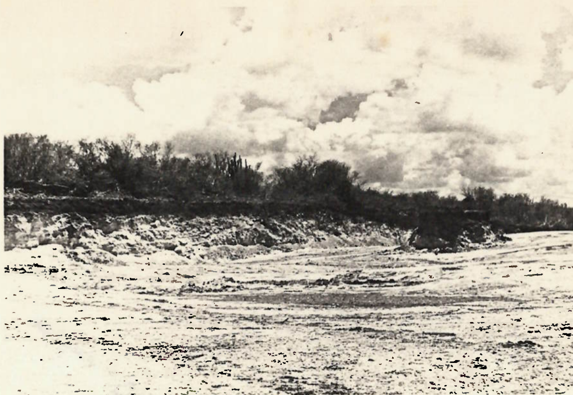
Foto 1.6 - Vista de área decapeada, pronta para o início da preparação da frente de lavra.
