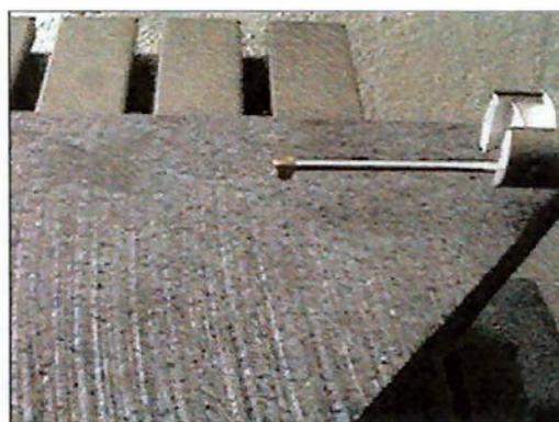
Fig. 27 Detalhe do estilete medindo GPP
