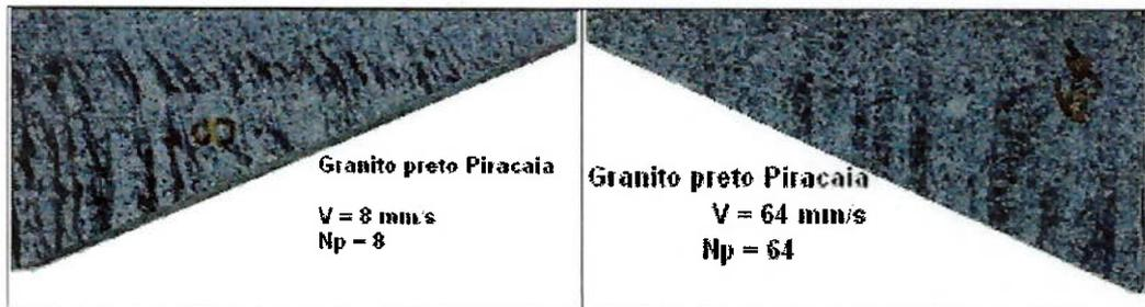
Fig. 79 Superfícies geradas pelo jato abrasivo em combinações distantes entre si.
