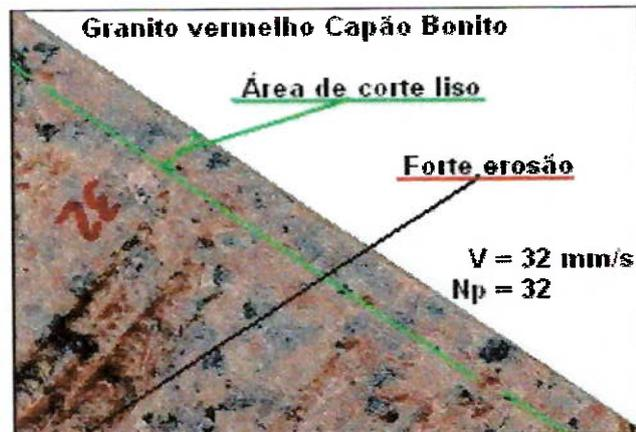
Fig. 82 Superfície gerada pelo jato abrasivo em GVCB (3)
