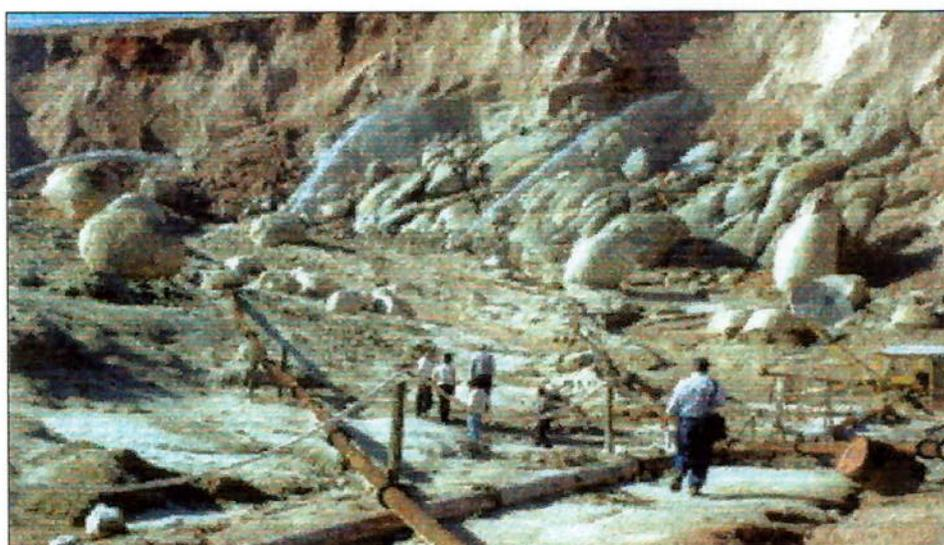
Fig. 2 Lavra hidráulica na pedreira da Viterbo Machado Luz Mineração Ltda. <sup>15</sup>
