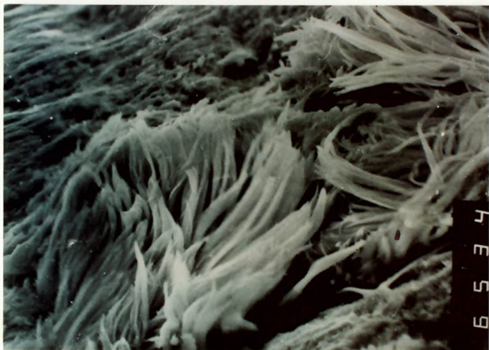
Foto 3 - Detalhe de agregados de fibras de crisotila sob microscópio eletrônico. Aumento de 1000X. Foto obtida de OLIVEIRA (6)
