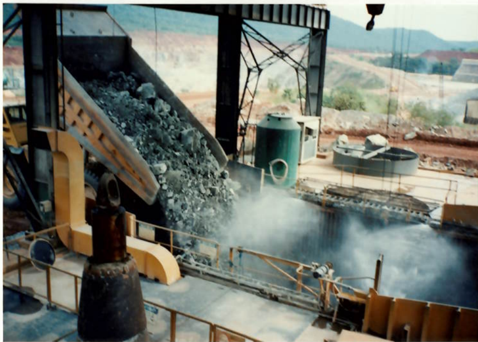
Foto 8 - Vista geral da alimentação do britador primário. Foto gentilmente cedida por OLIVEIRA, M.C.B.
