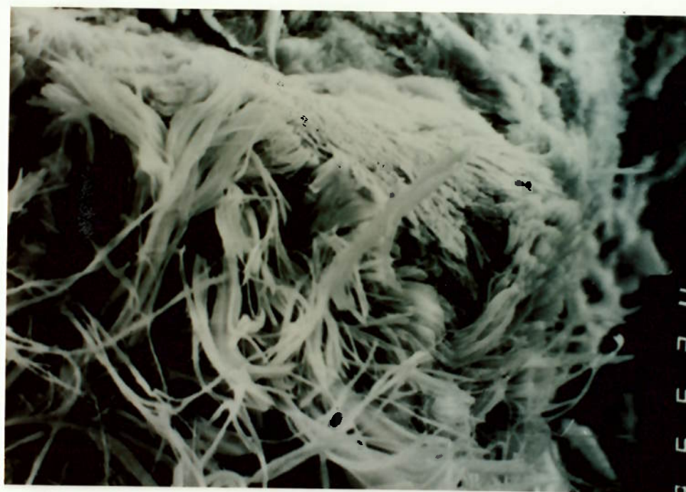
Foto 4 - Detalhe da matriz de rocha sob microscópio eletrônico. Notar agregados de fibras de crisotila. Aumento 1000X. Foto obtida de OLIVEIRA (6)
