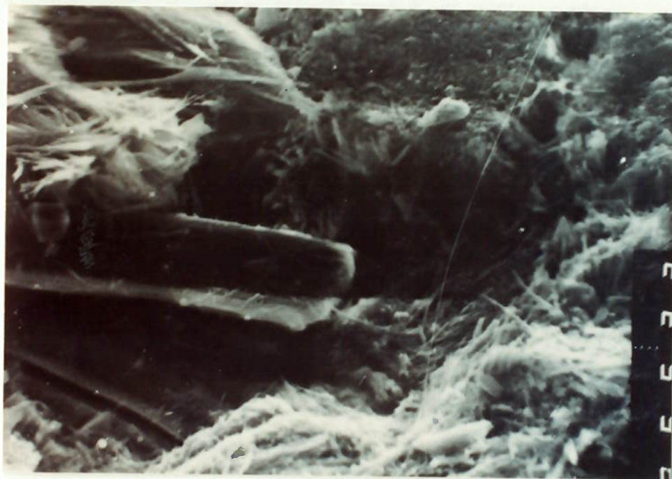
Foto 2 - Aspecto geral da matriz da rocha, formada principalmente por crisotila em agregados de fibras com comprimentos diferentes. Aumento 300X. Foto obtida de OLIVEIRA (6)
