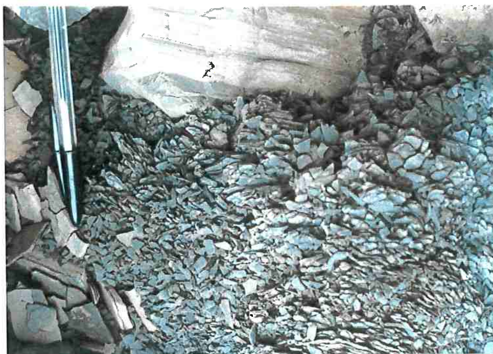
FIGURA 59 - ASPECTO DO FOLHELHO ALTERADO DA CAMADA INFERIOR, ADJACENTE AO SILTITO DA CAMADA INTERMEDIÁRIA, EM AMOSTRA EXPOSTA AO INTEMPERISMO POR MAIS DE TRINTA DIAS, MOSTRANDO A TÍPICA ALTERAÇÃO EM FORMA DE FLOCOS DO MINÉRIO DE MAIS ALTO TEOR NA JAZIDA
