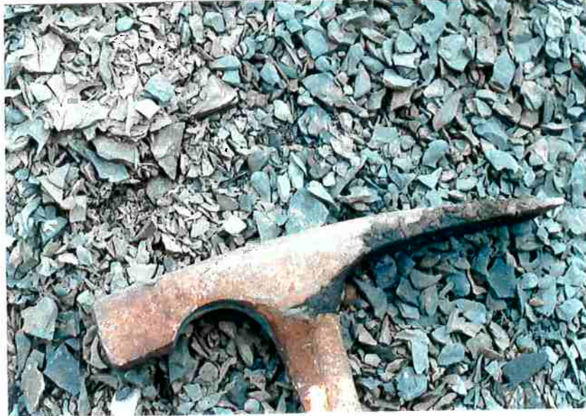
FIGURA 60- LASCAS CORTANTES PRODUZIDAS PELA FRAGMENTAÇÃO DE FOLHELHO OLEÍGENO DA PORÇÃO MÉDIA DA CAMADA INFERIOR OLEÍGENA, TÍPICAS DO FOLHELHO MAIS RESISTENTE E TENAZ DO DEPÓSITO
