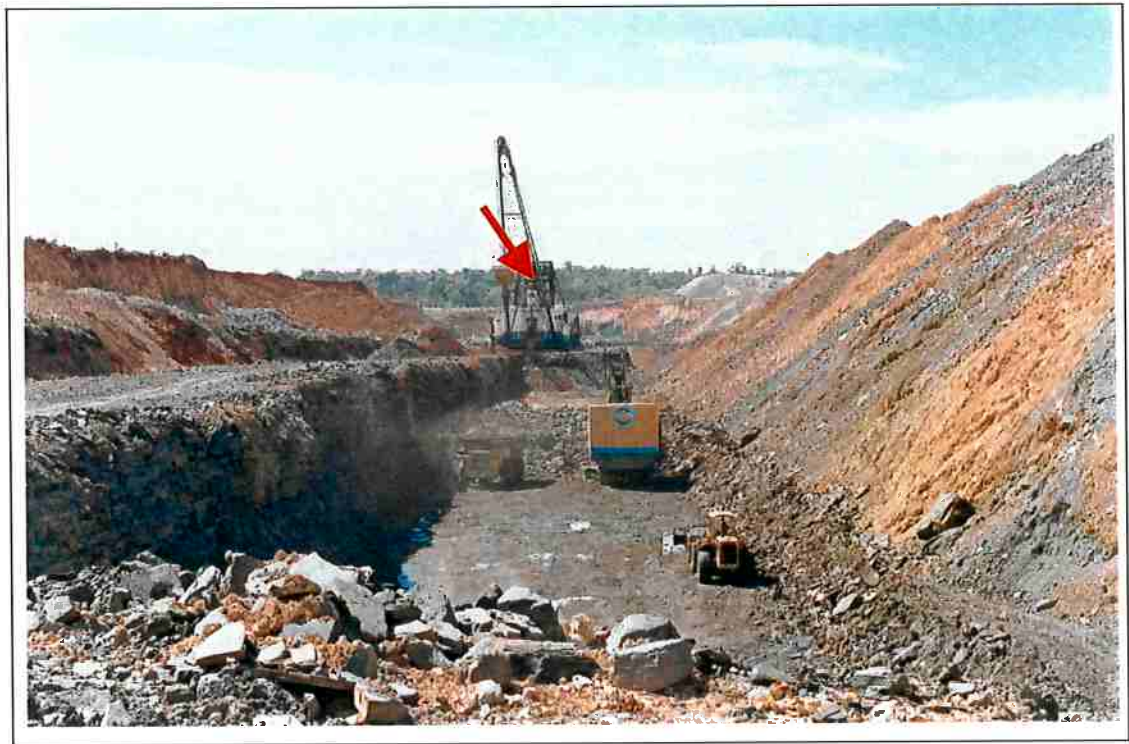
FIGURA 42 - LAVRA DE FOLHELHO OLEÍGENO, MOSTRANDO AO FUNDO A ESCAVATRIZ MARION E O PROCEDIMENTO DE CARREGAMENTO DOS CAMINHÕES DE MINÉRIO
