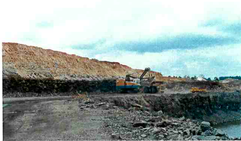
FIGURA 44 - CARREGAMENTO DO MINÉRIO DA CAMADA SUPERIOR DO DEPÓSITO
