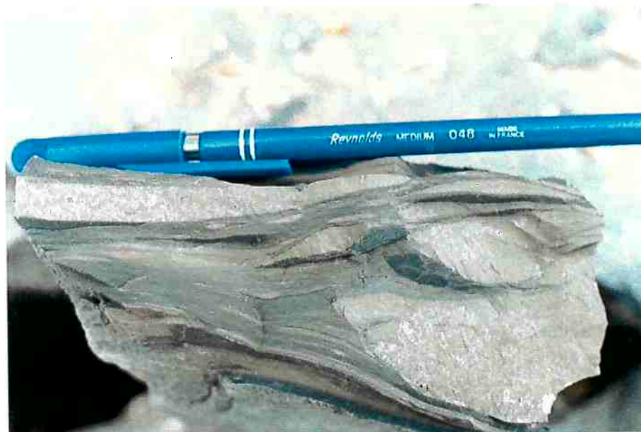
FIGURA 57 - INTERCRESCIMENTO ENTRE FRAÇÕES SILICÁTICAS E CARBONÁTICAS DO FOLHELHO, JUNTO A FAIXA DE CONTATO INFERIOR DA CAMADA SUPERIOR DE MINÉRIO
