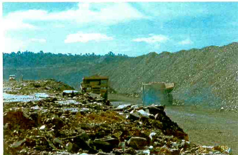
FIGURA 45 - VISTA DO TRÁFEGO DE CAMINHÕES FORA DE ESTRADA QUE TRANSPORTAM MINÉRIO E RECOLOCAM O FOLHELHO PIROLISADO NAS ESCAVAÇÕES NA MINA DE SÃO MATEUS DO SUL
