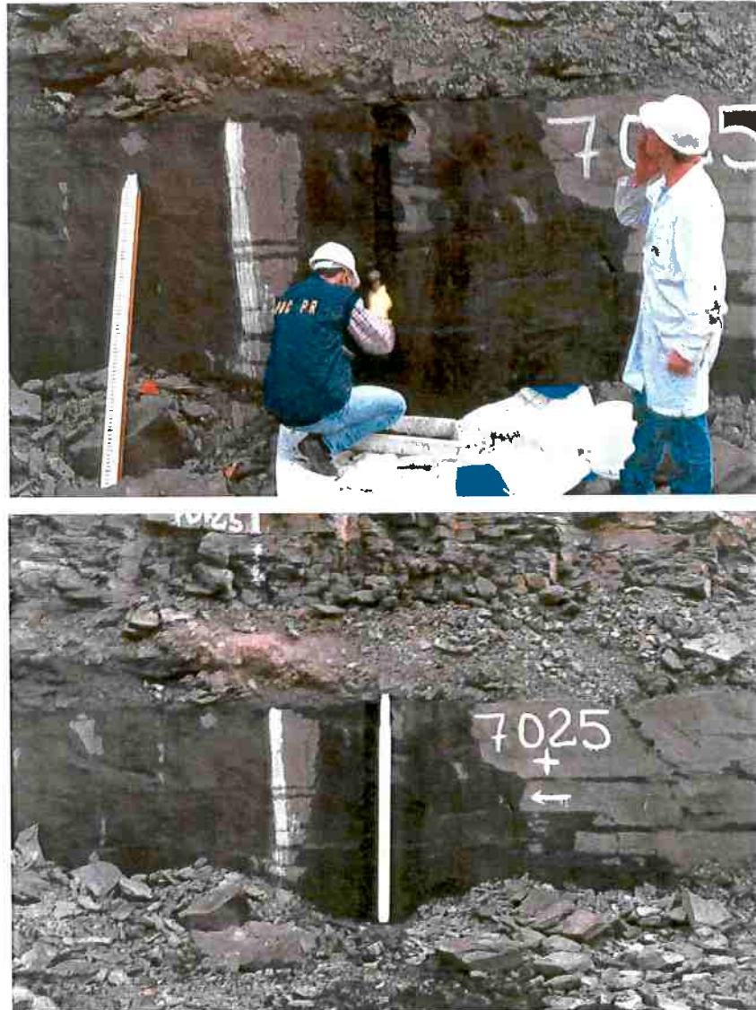
FIGURA 39 - CANAL DE AMOSTRAGEM ESCAVADO NA CAMADA INFERIOR DE MINÉRIO, COM DIMENSÕES DE 20CM DE LARGURA, 10CM DE PROFUNDIDADE E 3M DE EXTENSÃO
