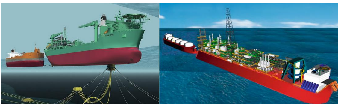
Figura 16- Operação de offloading ou de alívio [Fontes:Bluewater e PRN online]
