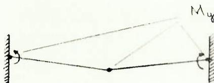
Figura II.4 - Mecanismo tri-articulado
