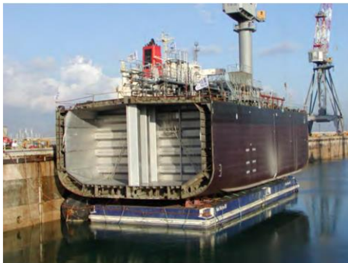
Figura 3.29 - Compartimento de carga em 2205 de um módulo de um navio-tanque, adaptado de [12].
