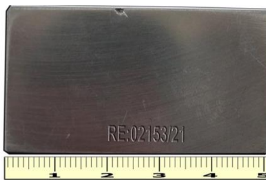
Figura 5.34 - Resultado do ensaio de corrosão por pites segundo a G48 mostrando que ocorreram pites nas superfícies do corpo de prova da junta com reparo.
