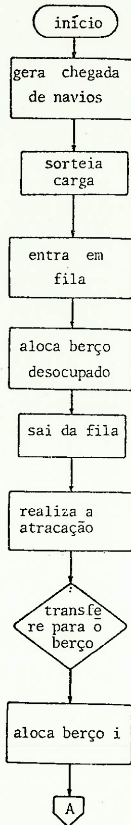
figura 20 - Fluxograma do modelo GPSS para o Terminal de Fertilizante e o Terminal de Minérios.
