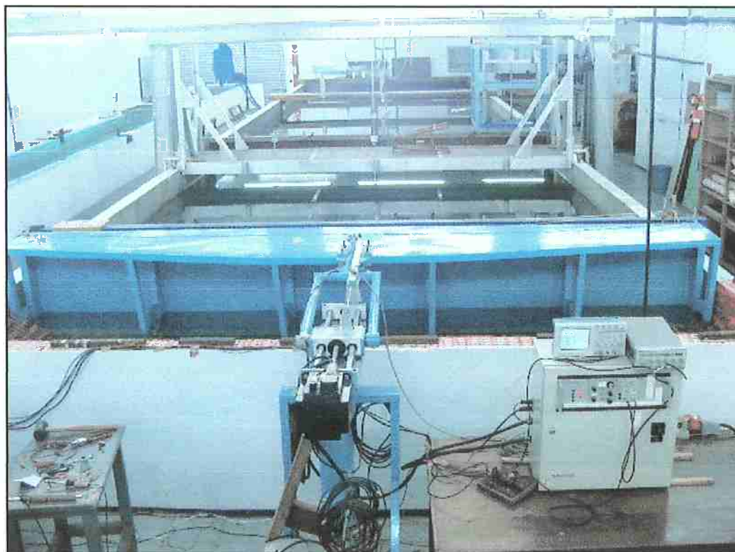
Figura V.2 - Vista geral do tanque, de montante para jusante. Em primeiro plano os sistemas de controle e de acionamento do atuador.
