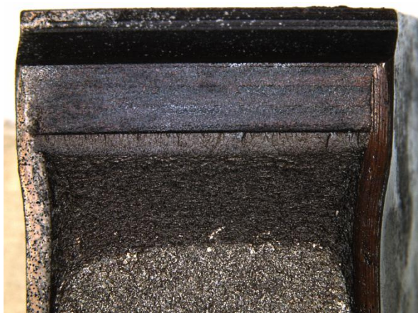
Figura 26 - Fotomicrografia da Fratura do corpo de prova número 3 de metal base. Fonte: próprio autor
