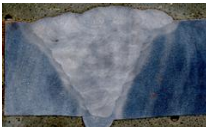
Figura 9 - Macrografia da junta soldada fonte: próprio autor
