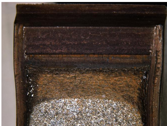
Figura 24 - Fotomicrografia da Fratura do corpo de prova número 1 de metal base. Fonte: próprio auto
