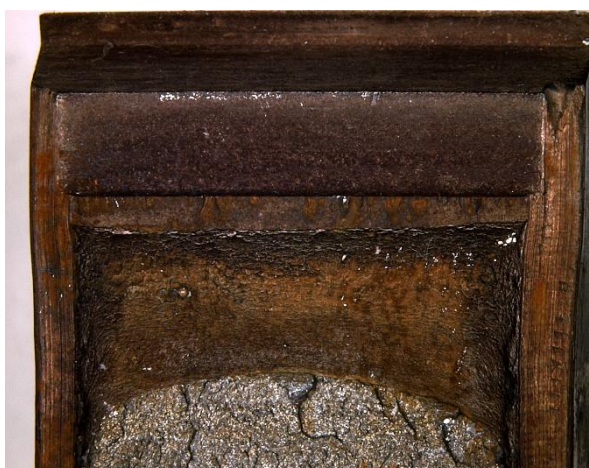
Figura 28 - Fotomicrografia da Fratura do corpo de prova número 3 de metal de solda. Fonte: próprio autor
