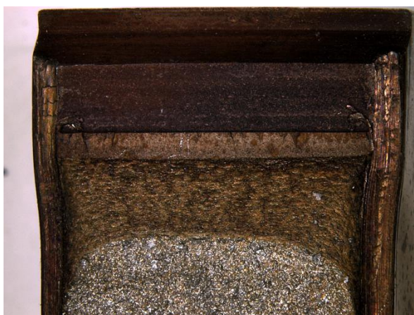
Figura 25 - Fotomicrografia da Fratura do corpo de prova número 2 de metal base. Fonte: próprio autor
