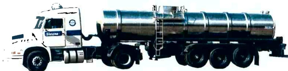
Fig. 7.2 – Semi-Reboque Tanque Tracionado com Cavallo Mecânico
