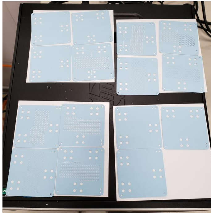
Figura 9 – Camadas do microdispositivo “Reator A” após o corte a laser das folhas de LTCC.
