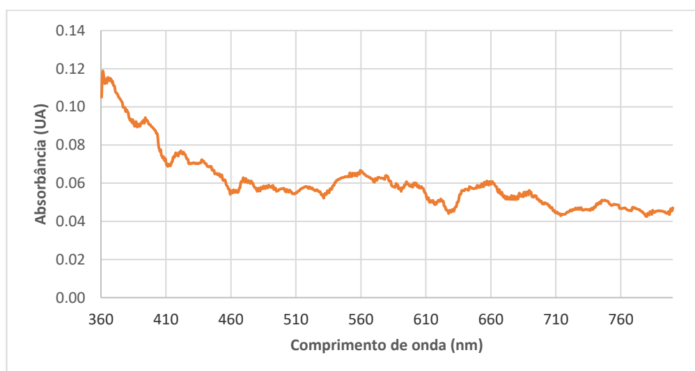
Figura 37 – Espectro de absorbância de luz da amostra BTurk02 (reação de Turkevich com tempo de residência de 900 s).
