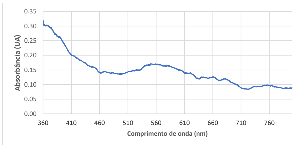
Figura 36 – Espectro de absorbância de luz da amostra BTurk01 (reação de Turkevich com tempo de residência de 300 s).
