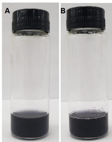
Figura 48 – Aspecto visual de amostra resultante da síntese de AuNPs com NaCt 7,5 mM, sal de ouro 2,5 mM, tempo de residência de 90 s no dispositivo “Reator B” conduzida a 25 °C. A) Sem nenhum tratamento adicional; B) Após 1h em banho a 100 °C.
