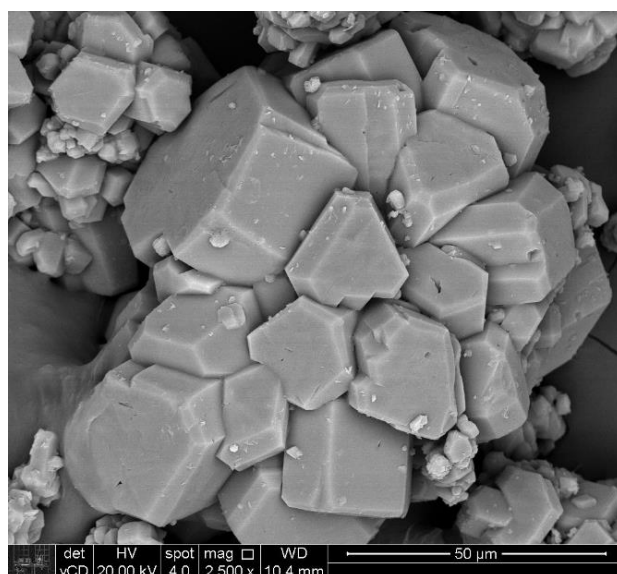
Figura 49: Imagem 2.500 x obtida no MEV para a hidróxido de alumínio precipitado na solução Com tratamento de purificação
