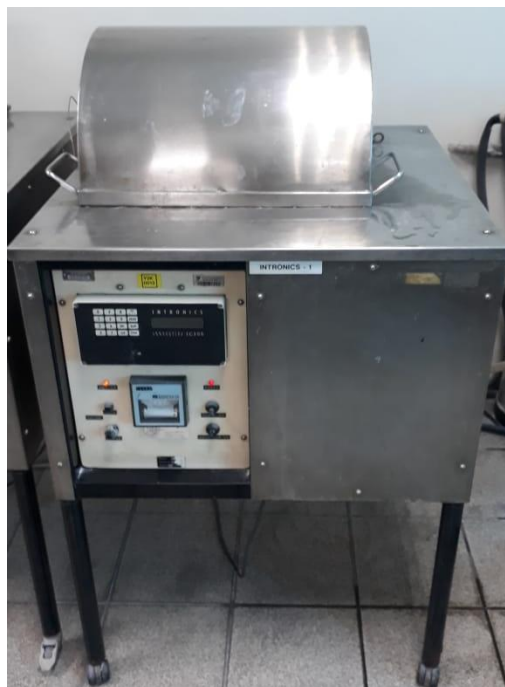
Figura 31: equipamento Intronic utilizado para simular a etapa de precipitação
