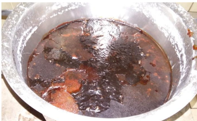
Figura 35: Solução de aluminato de sódio após o processo de evaporação
