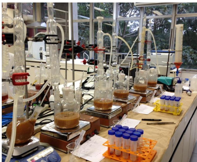
Figura 33: Aparato montado para ensaios de causticização da fração sólida (impurezas)
