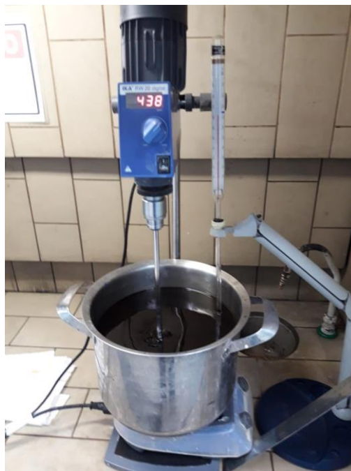
Figura 29: aparato montado para simular o processo de evaporação da solução
