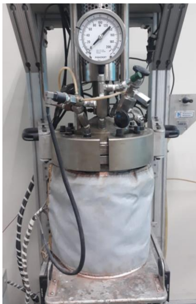
Figura 30: digestor Parr utilizado para solubilização do hidróxido de alumínio
