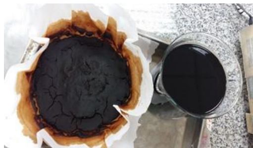
Figura 40: Fração sólida (Impurezas) precipitada após o processo de evaporação e o licor purificado
