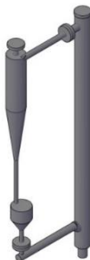
Figura 4.8 – Detalhe do Reator Fotocatalítico de Arraste modelado em 3D. (Fonte: Relatório FAPESP, 2017)
