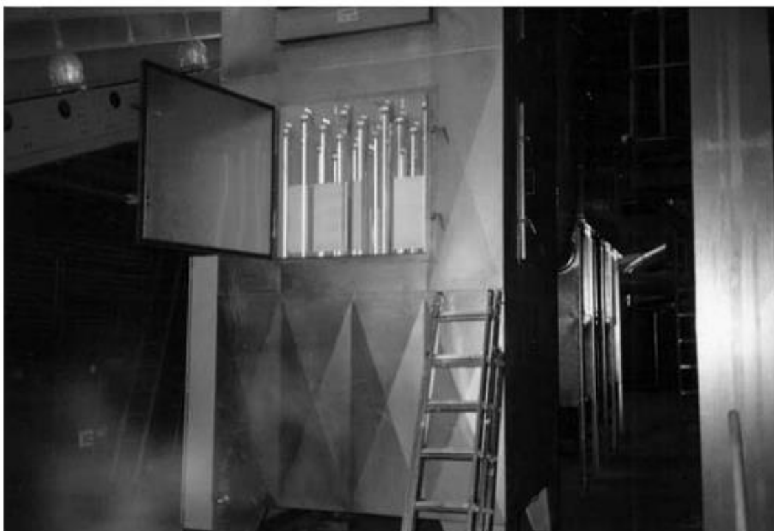
Figura 2.6 – Reator fotocatalítico para tratamento de correntes de ar de lixo com odor contendo 24 lâmpadas LP-Hg (Heraeus NNI 120/84, P_{el} = 120W cada, máxima vazão volumétrica de 20.000 \text{ m}^3/h ). (Fonte: OPPENLÄNDER, 2003)
