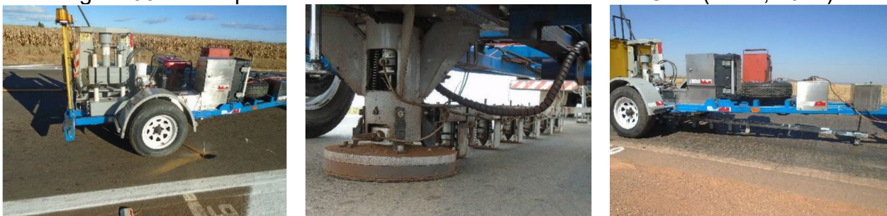
Figura 35 - Exemplo de levantamento deflectométrico nas UA's (DNIT, 2017)
