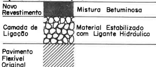
Figura 1.2 Diversos tipos de pavimentos semi-rígidos
