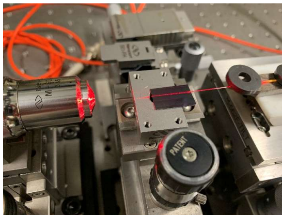
Figura 39 - Guiamento óptico através do comprimento total em guias de onda com núcleo de \text{SiO}_x\text{N}_y Fonte: Autor
