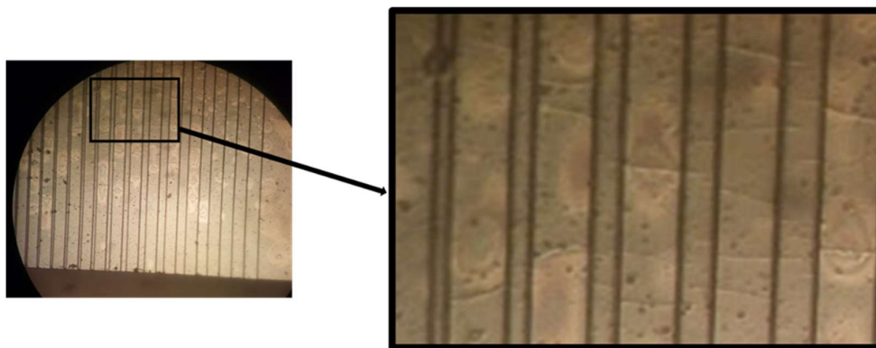
Figura 27 – Micrografia da superfície com os guias de onda de AlN após recozimento a 550 °C
