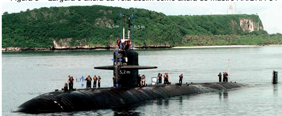
Figura 5 – Largura e altura da vela assim como altura do mastro AN/BRA-34
