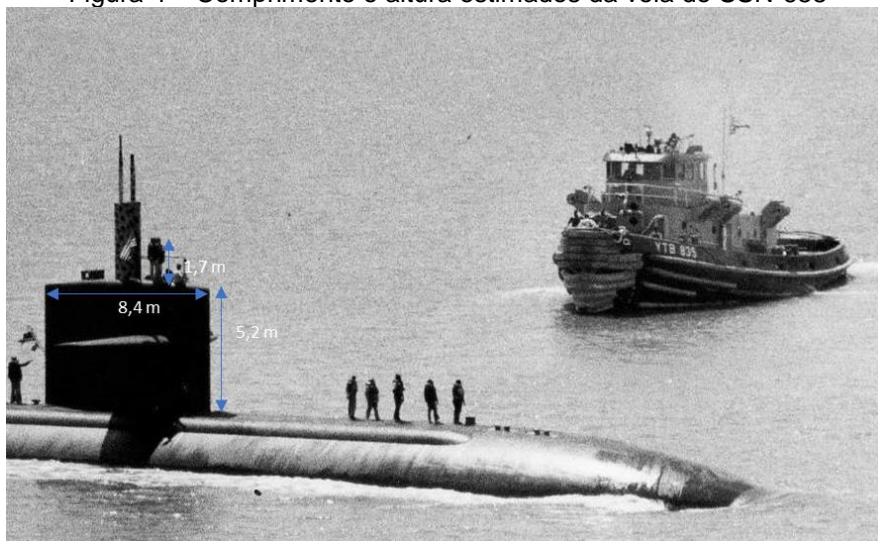
Figura 4 – Comprimento e altura estimados da vela do SSN-688
