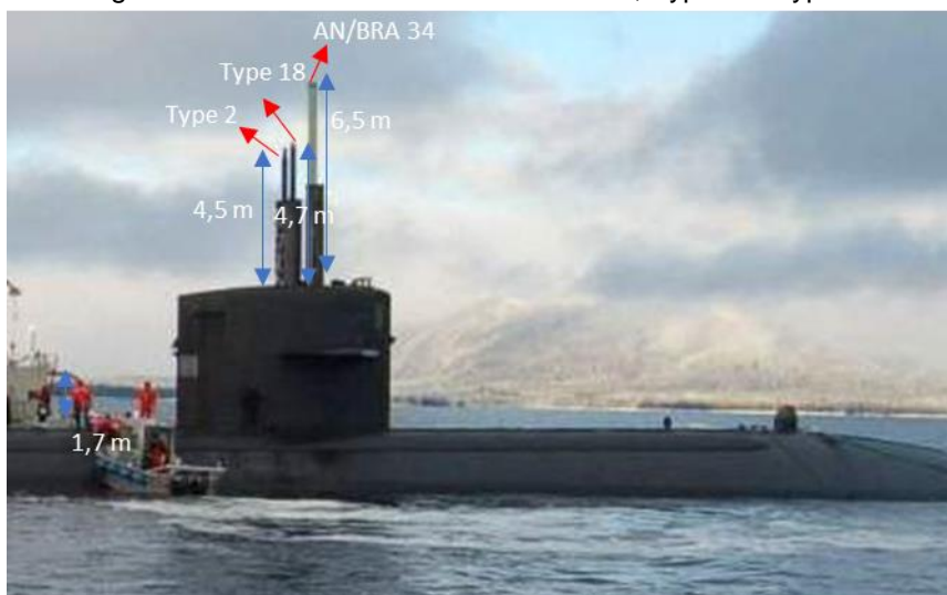
Figura 6 – Altura dos mastros AN/BRA-34, Type 2 e Type 18
