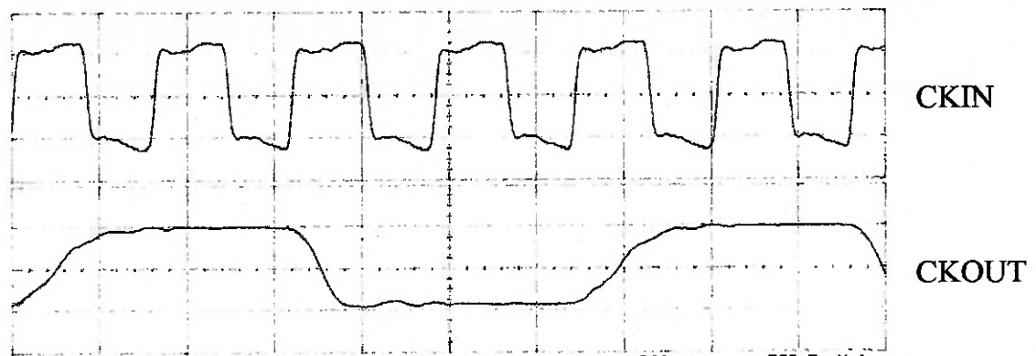
Figura 5.5.b Entrada e saída dos sinais de relógio no Demultiplexador, modo 1:4; taxas de 622Mb/s e 155 Mbit/s, respectivamente. V_{SW} = 1V , @R_{load} = 50\Omega
