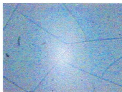
Figura 4.2.3.14.: Ruptura da camada de PMMA devido à tensão mecânica ocorrida durante a etapa de cura.
