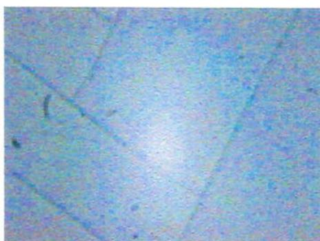
Figura 4.2.3.13.: Ruptura da camada de PMMA devido à tensão mecânica ocorrida durante a etapa de cura.
