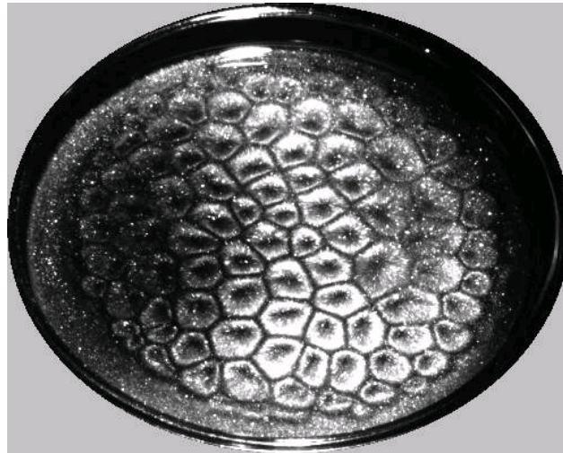
Figura 4: Vista geral do recipiente e das células da "instabilidade de Bénard" (Fonte: www.physiology.rwth-aachen.de/user/jaeger/diplom/ )
