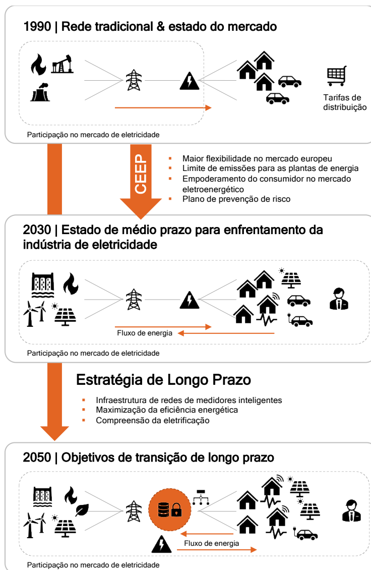
Figura 14 - Rota estratégica para a incorporação de RED e RD no sistema elétrico europeu.
