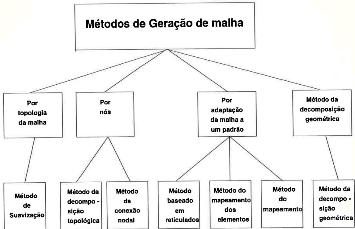
**Figura 4.1** Classificação dos métodos de geração de malhas de elementos finitos[10]
