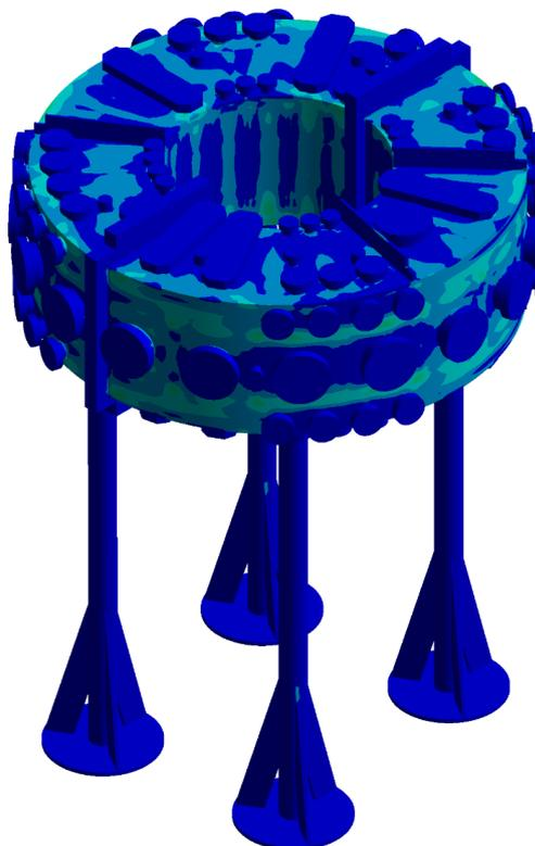
Figura 44 – Tensões equivalentes produzidas no sistema analisado no modelo 7.
