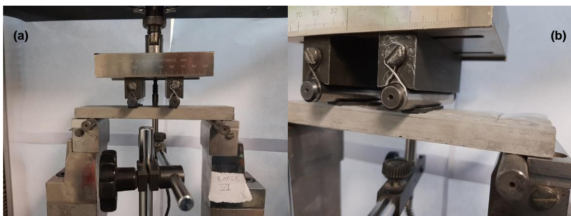
Figura 53 Ensaio de tração na flexão em quatro pontos. Em (a) o aparato montado com o corpo de prova cimentício. Em (b) detalhe para inserção de uma borracha para distribuir os esforços homogeneamente.
