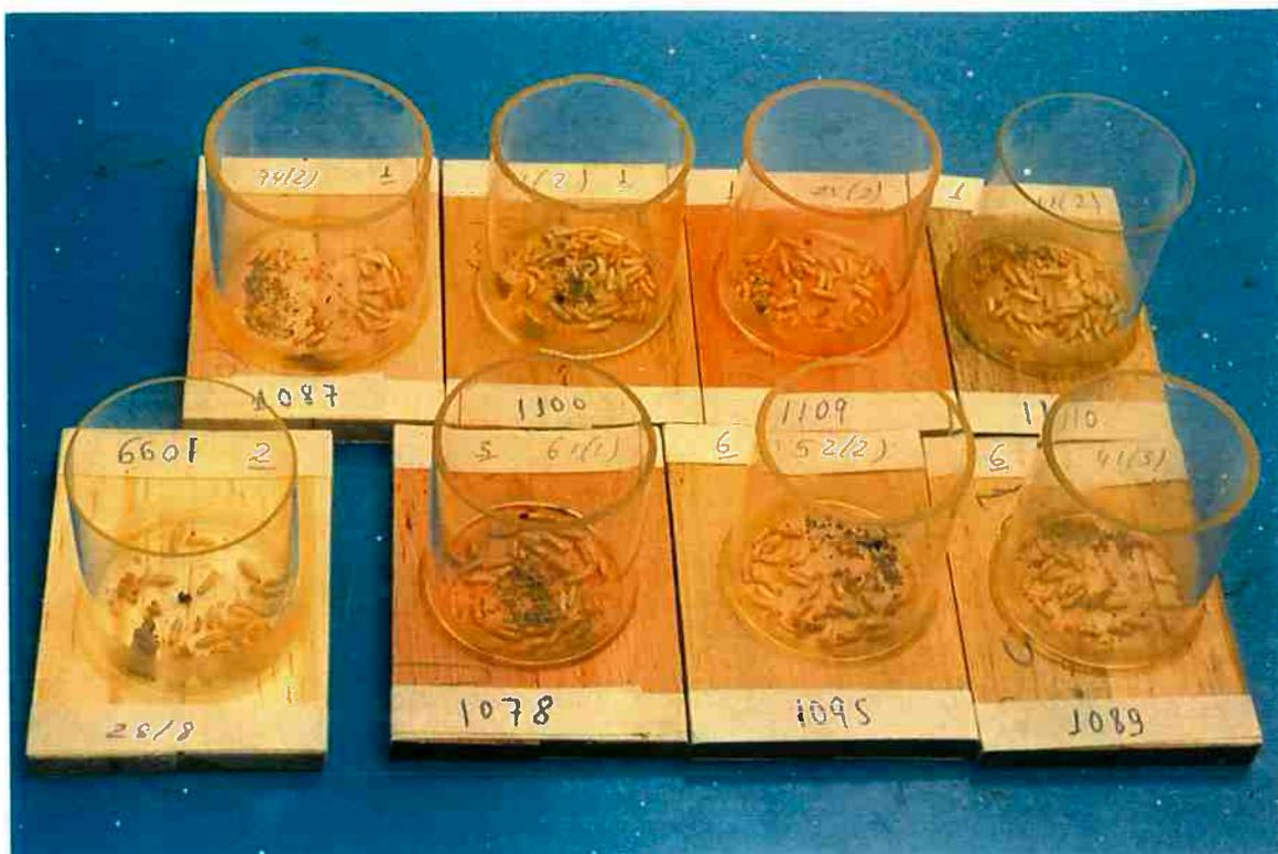
**Figura 29** Fotografia ilustrando o ensaio de cupim de madeira seca para sete espécies de *Eucalyptus*.
