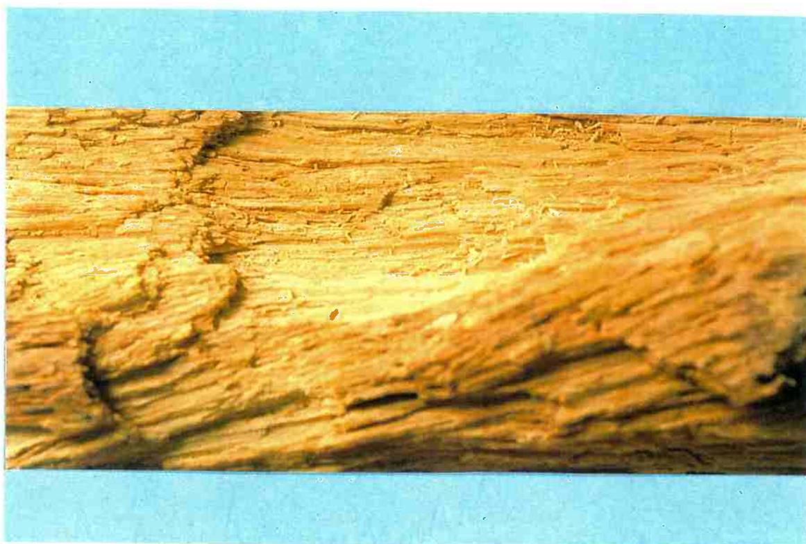
**Figura 25** Madeira de angelim vermelho (*Hymenolobium sp*) severamente atacada por podridão branca. Notar a natureza fibrosa e esbranquiçada deste tipo de apodrecimento.
