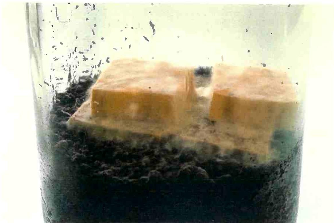
**Figura 30** Fotografia mostrando um frasco com dois corpos-de-prova submetidos ao ataque do fungo *Gloeophyllum trabeum* no ensaio de apodrecimento acelerado em laboratório.
