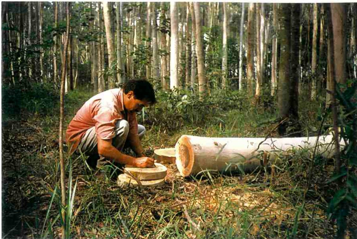
**Figura 27** Fotografia mostrando a operação de coleta de disco (amostras) de uma árvore de *Eucalyptus citriodora*.
