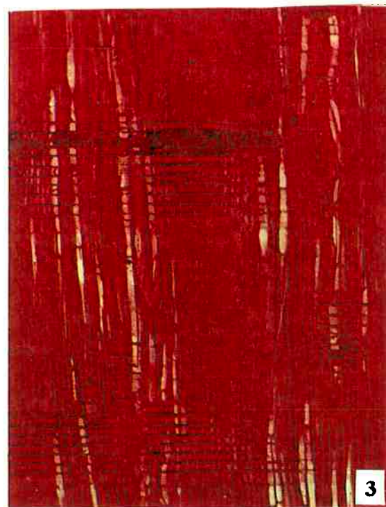
Figura 51 Fotomicrografias mostrando a seção transversal (1), longitudinal tangencial (2) e longitudinal radial (3) da madeira de E. urophylla . X90.
