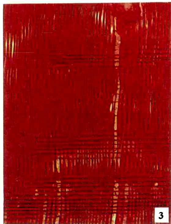
Figura 52 Fotomicrografias mostrando a seção transversal (1), longitudinal tangencial (2) e longitudinal radial (3) da madeira de E. grandis . X90.
