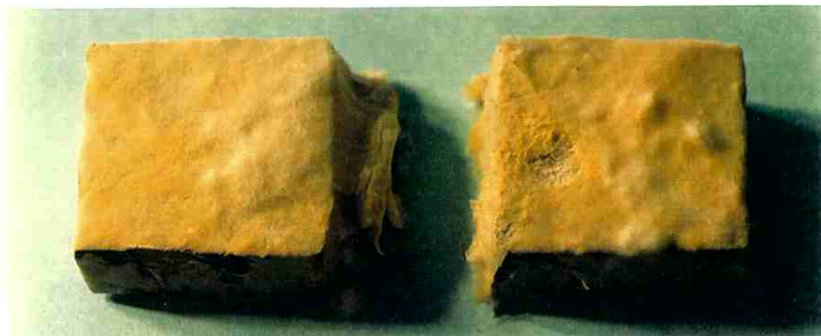
Figura 62 Fotografia realçando o crescimento considerável e conseqüente ataque do fungo Gloeophyllum trabeum , à madeira de P. elliottii , que foi tomada como referência para o ensaio de apodrecimento acelerado de laboratório da madeira de sete espécies de Eucalyptus .
