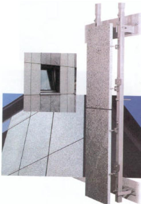
**Figura 2-10-Placas pétreas fixadas com o auxílio de uma subestrutura auxiliar (TECTÓNICA, 1997)**
