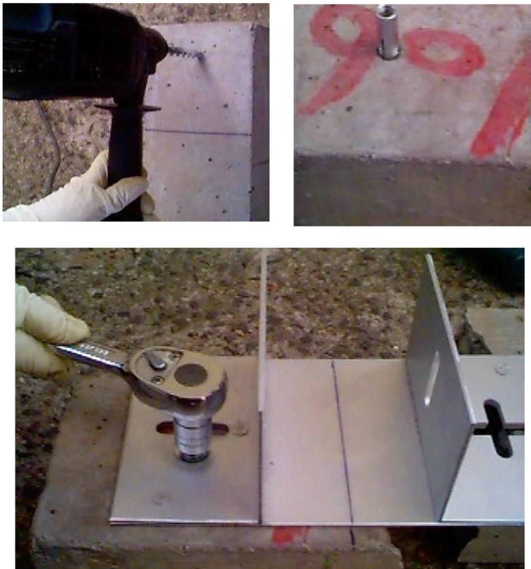
*Figura 4-7-Fixação da ancoragem ao substrato (CEUSA; LEME, 2002)*
