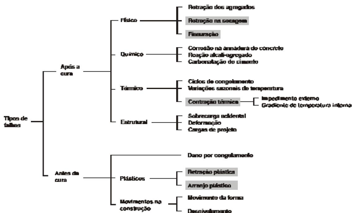
Figura B- 2- Causas das falhas de fixação (SENKIW e LANCELOT III, 1991).
