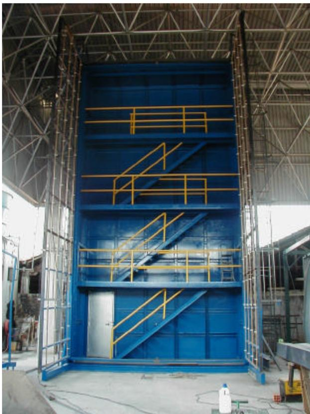
**Figura D- 1 - Câmara para ensaio de fachadas-cortina pertencente à AFEAL.**
