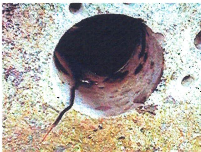
**FOTO 4.23 - Solda do fio para conectar a barra de aço ao Gecor6**
