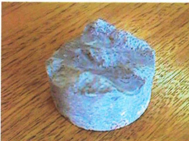
**FOTO 4.16** - Pasta entre o concreto e a barra de aço - "efeito parede"
