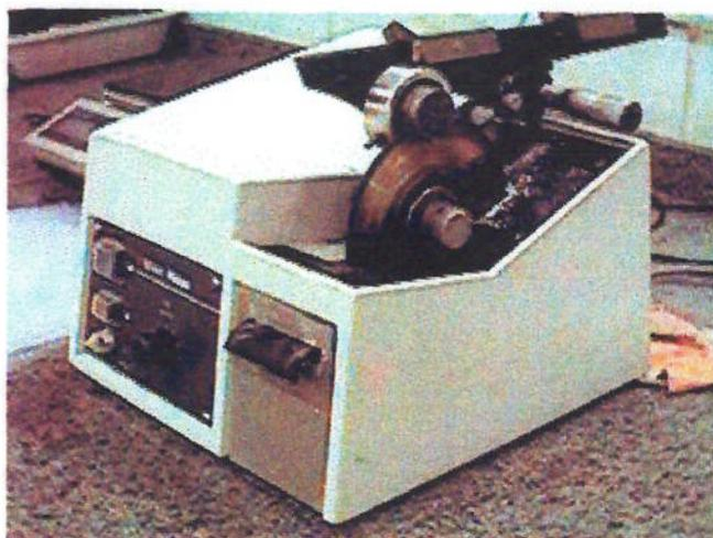
**FOTO 5.3** - Equipamento para fatiamento dos corpos de prova em lâminas de 2 mm de espessura
