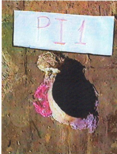
**FOTO 4.22** -Ensaio de profundidade de carbonatação com solução de fenolftaleína (coloração vermelha) e solução de timolftaleína (coloração azul)
