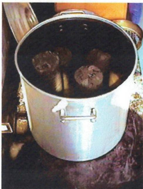
**FOTO 4.8** - Testemunhos submersos em água no ensaio de absorção de água, índice de vazios e massa específica
