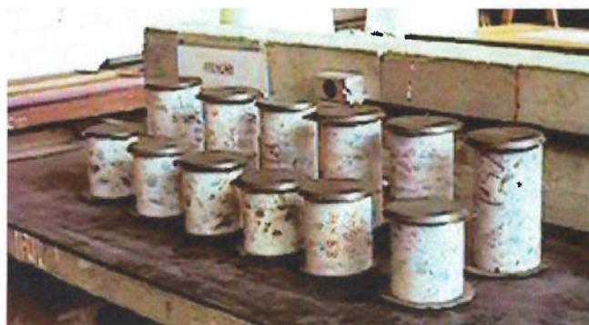
**FOTO 4.1** - Preparo dos testemunhos para os ensaios de compressão e módulo de elasticidade
