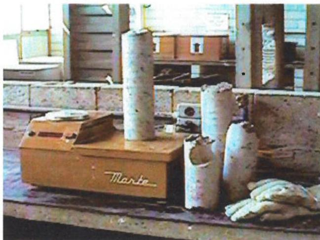
**FOTO 4.7** - Medida de massa dos testemunhos para ensaio de absorção de água, índice de vazios e massa específica
