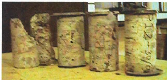
**FOTO 4.6 - Módulo de elasticidade - Testemunhos rompidos: PS3, PI5, PS5 e PI2**
