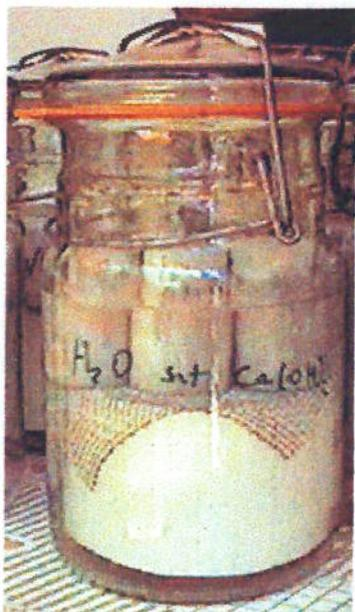
FOTO 5.2 - Corpos de prova do Grupo GS a 100 %: parcialmente submersos em solução saturada com  $\text{Ca(OH)}_2$
