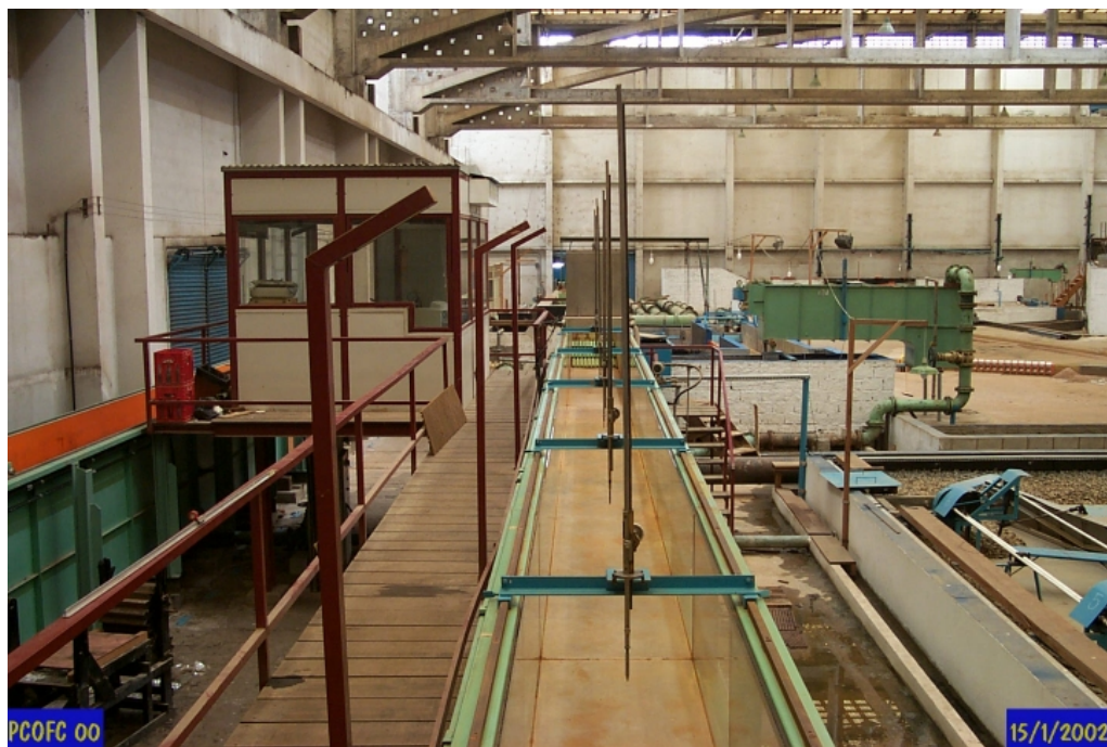
Foto 2: Vista da seção transversal de ensaio e pontas limnimétricas para medição do nível d'água.
