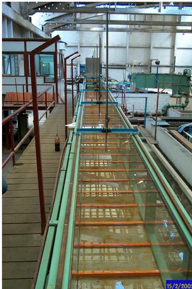
Foto 11: Vista longitudinal do canal experimental com macro-rugosidade instalada e as pontas de leitura de nível
