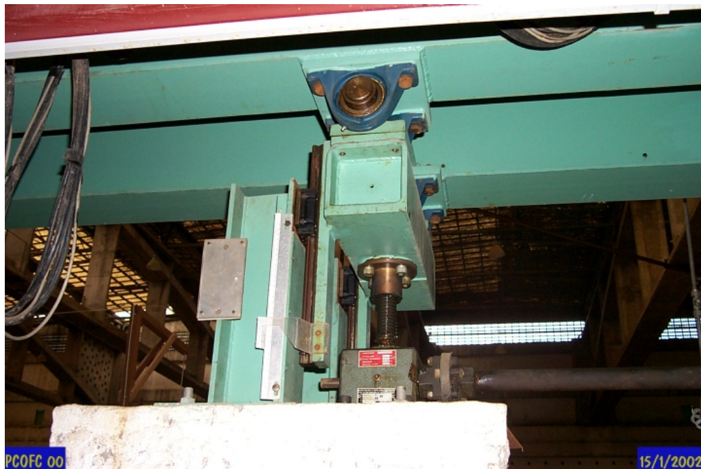
Foto 4: Servo-motor e dispositivo de inclinação do fundo do canal.
