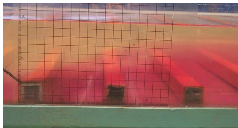
Foto 12: Comportamento da camada de interferência hiper-turbulenta em função do espaçamento longitudinal dos obstáculos
